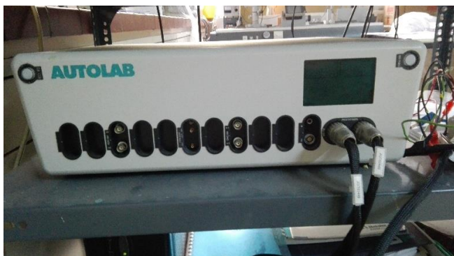
Σχήμα 23: Τροφοδοτικό μηχάνημα (ποτενσιοστάτης) AUTOLAB PGSTAT302N .
