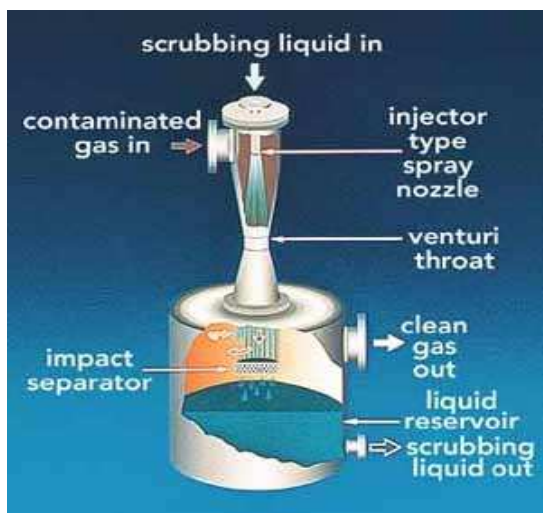
Εικόνα 3. 21 Διάταξη Venturi ( http://www.hkvac.co.in/scrubber.htm )
