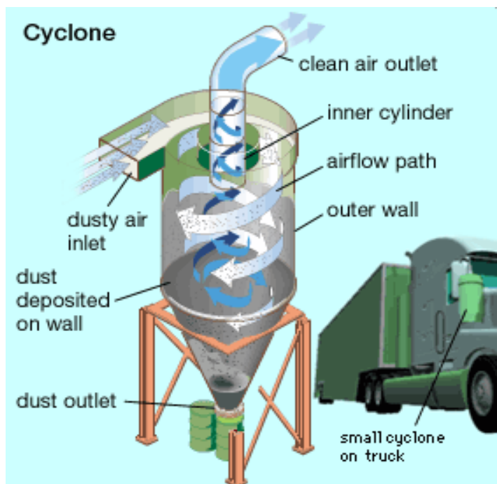
Εικόνα 3.14 Λειτουργίας κυκλώνα ( www.britannica.com )
