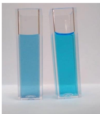
Εικόνα 22. Αριστερά MB μετά από 120 min με καταλύτη Pd - Co σε UV ακτινοβολία Δεξιά MB αρχικό διάλυμα.
