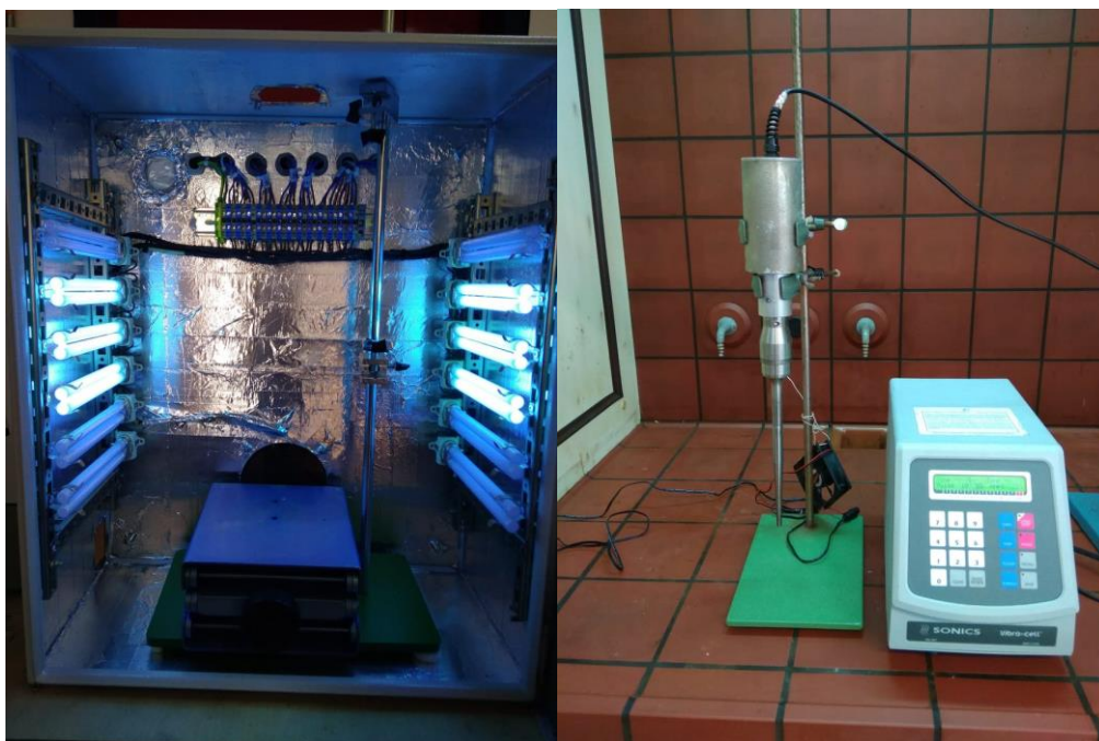
Εικόνα 12. Αριστερά φωτοκαταλυτικός θάλαμος με λάμπες UV. Δεξιά συσκευή υπερήχων.
