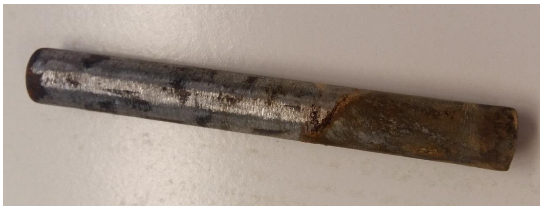
Σχήμα 3. 19: Σιδερένια ράβδος έπειτα από έκθεση σε πυκνότητα ρεύματος i=0.03\text{A}/\text{cm}^2 για 34 λεπτά, εντός χώματος ειδικής αγωγιμότητας 41\text{K}\Omega\cdot\text{cm} με φύλλο χαλκού ως άνοδο και ηλεκτρόδιο γείωσης ως κάθοδο και έχοντας αφεθεί σε ατμοσφαιρικό περιβάλλον για 1 ημέρα μετά τη μέτρηση
