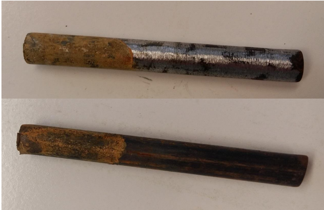
Σχήμα 3. 16: Καθαρή χαλύβδινη (επάνω) και σκουριασμένη (κάτω) ράβδοι έπειτα από έκθεση σε πυκνότητα ρεύματος i=0.03\text{A}/\text{cm}^2 για 34 λεπτά, εντός χώματος ειδικής αγωγιμότητας 41\text{K}\Omega\cdot\text{cm} με φύλλο χαλκού ως άνοδο και ηλεκτρόδιο γείωσης ως κάθοδο
