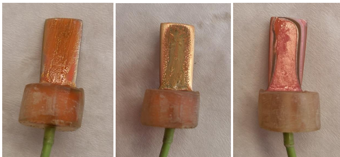
Σχήμα 3. 15: Ηλεκτρόδιο χαλκού έπειτα από έκθεση σε πυκνότητες ρεύματος i=0.25\text{A}/\text{cm}^2 για 10min (αριστερά), i=0.5\text{A}/\text{cm}^2 για 5min (κέντρο), i=1\text{A}/\text{cm}^2 για 2.5min (δεξιά) εντός διαλύματος 5 \times 10^{-5}\text{M NaOH} και 0.375\text{M CuSO}_4 , \text{pH}=7
