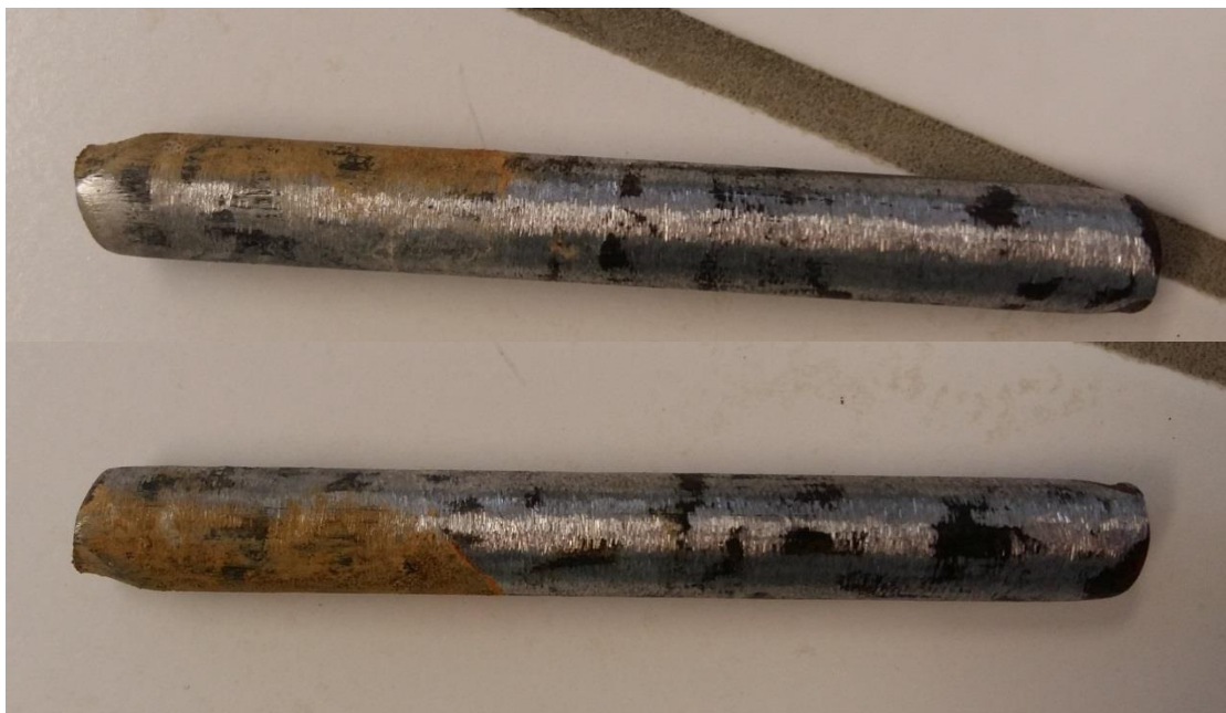
Σχήμα 3. 17: Καθαρή χαλύβδινη ράβδος έπειτα από έκθεση σε πυκνότητα ρεύματος i=0.03\text{A}/\text{cm}^2 για 34 λεπτά, εντός χώματος ειδικής αγωγιμότητας 41\text{K}\Omega\cdot\text{cm} με φύλλο χαλκού ως άνοδο και ηλεκτρόδιο γείωσης ως κάθοδο
