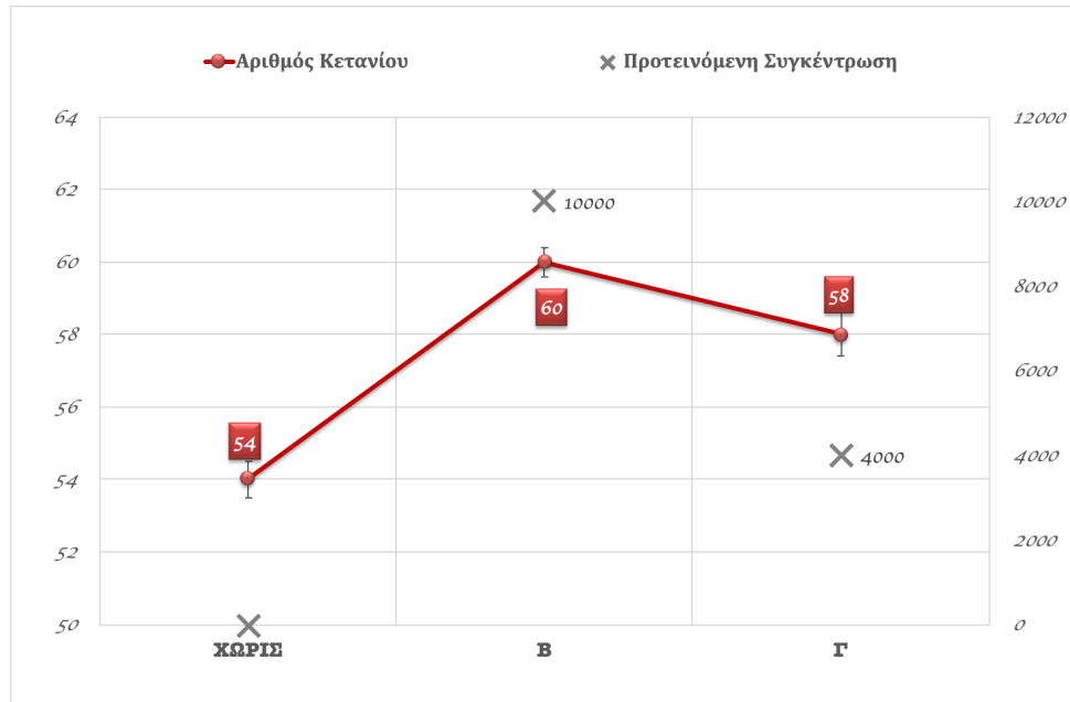
Σχήμα 9-5: Αύξηση του αριθμού κετανίου στα μίγματα Β7 μετά την εισαγωγή των βελτιωτικών προσθέτων Β και Γ.
