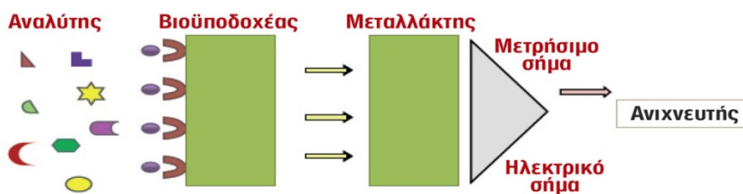
Σχήμα 2.4. Σχηματική απεικόνιση λειτουργίας ενός βιοαισθητήρα.
