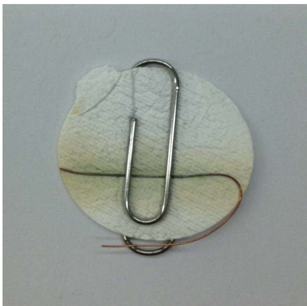
Σχήμα 8.2. Φωτογραφία του κατασκευασθέντος βιοαισθητήρα της σαξιτοξίνης.
