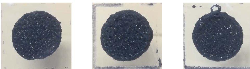
Πίνακας 9: Τριδιάστατα εκτυπωμένες υδρογέλες με παραμέτρους T = 15 \text{ }^\circ\text{C} , D = 0,25 \text{ mm} , PS = 400 \text{ }\mu\text{m} , F=1,5 .
