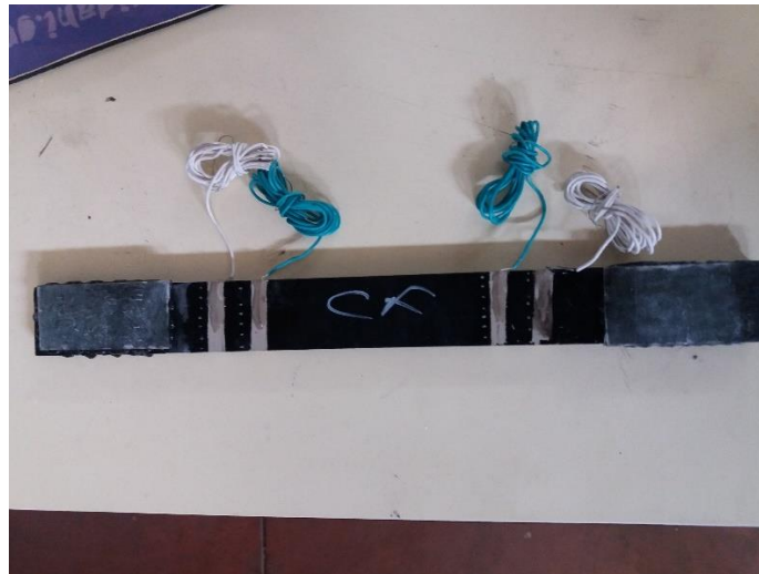
Εικόνα 7.4. Ηλεκτρικές επαφές σε δοκίμιο κόπωσης για την μέτρηση ηλεκτρικής αντίστασης κατ' όγκο
