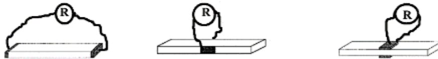
Εικόνα 3.2. Τοποθέτηση επαφών σε ορθογωνικά δοκίμια για τη μέτρηση της ηλεκτρικής αντίστασης. Αριστερά: Διαμήκης ( R_{long} ), Μέση: Δια μέσου του πλάτους ( R_{tw} ), Δεξιά: Δια μέσου του πάχους ( R_{tt} )
