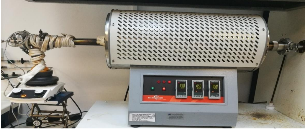
Εικόνα 5.1. Φωτογραφία πειραματικής διάταξης CVD
