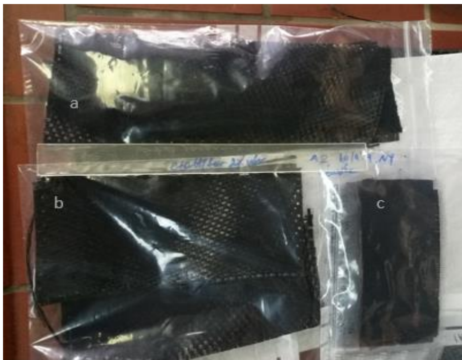
Εικόνα 5.4. Τροποποιημένα Υφάσματα με CNTs/CNFs για (a) δοκίμια κόπωσης, (b) δοκίμια εφελκυσμού και (γ) δοκίμια κάμψης/διάτμησης.
