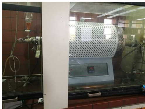
Εικόνα 5.3. Φωτογραφία πειραματικής διάταξης πιλοτικού CVD
