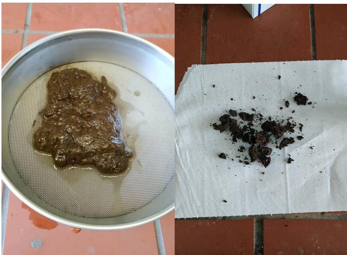
Εικόνα 14. Κροκιδωμένο στερεό χωνεμένου υπολείμματος πριν (αριστερά) και μετά (δεξιά) την 24ωρη ξήρανση.
