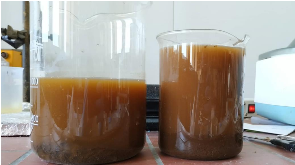
Εικόνα 13. . Κροκιδωμένο digestate με προσθήκη 100 ml (αριστερά) και 60 ml (δεξιά) κροκιδωτικού διαλύματος.
