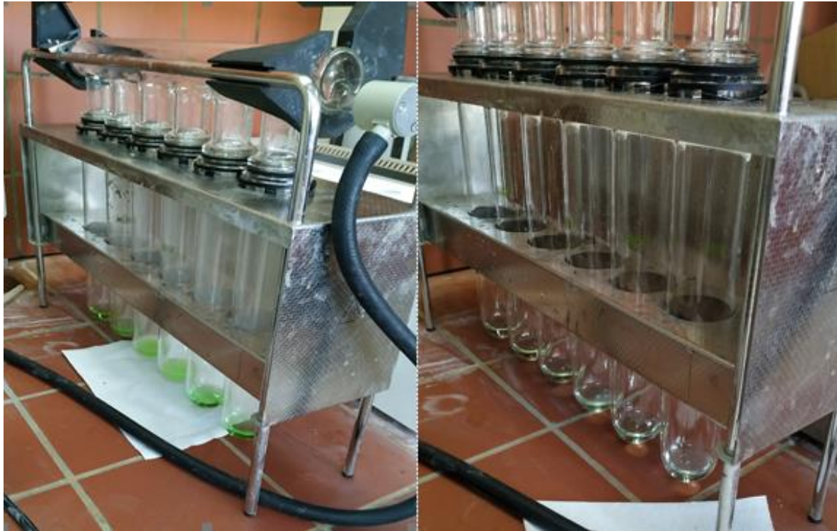
Εικόνα 11. Φιάσκες με δείγμα αμέσως μετά τη χώνευση (αριστερά) και μισή ώρα μετά τη χώνευση (δεξιά)
