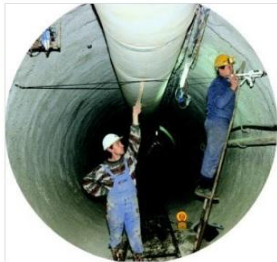
Εικόνα 1. 1: Μηκυνσιόμετρο ταινίας και στιγμιότυπο από χρήση του σε πραγματικές συνθήκες (Riaz, 2015)
