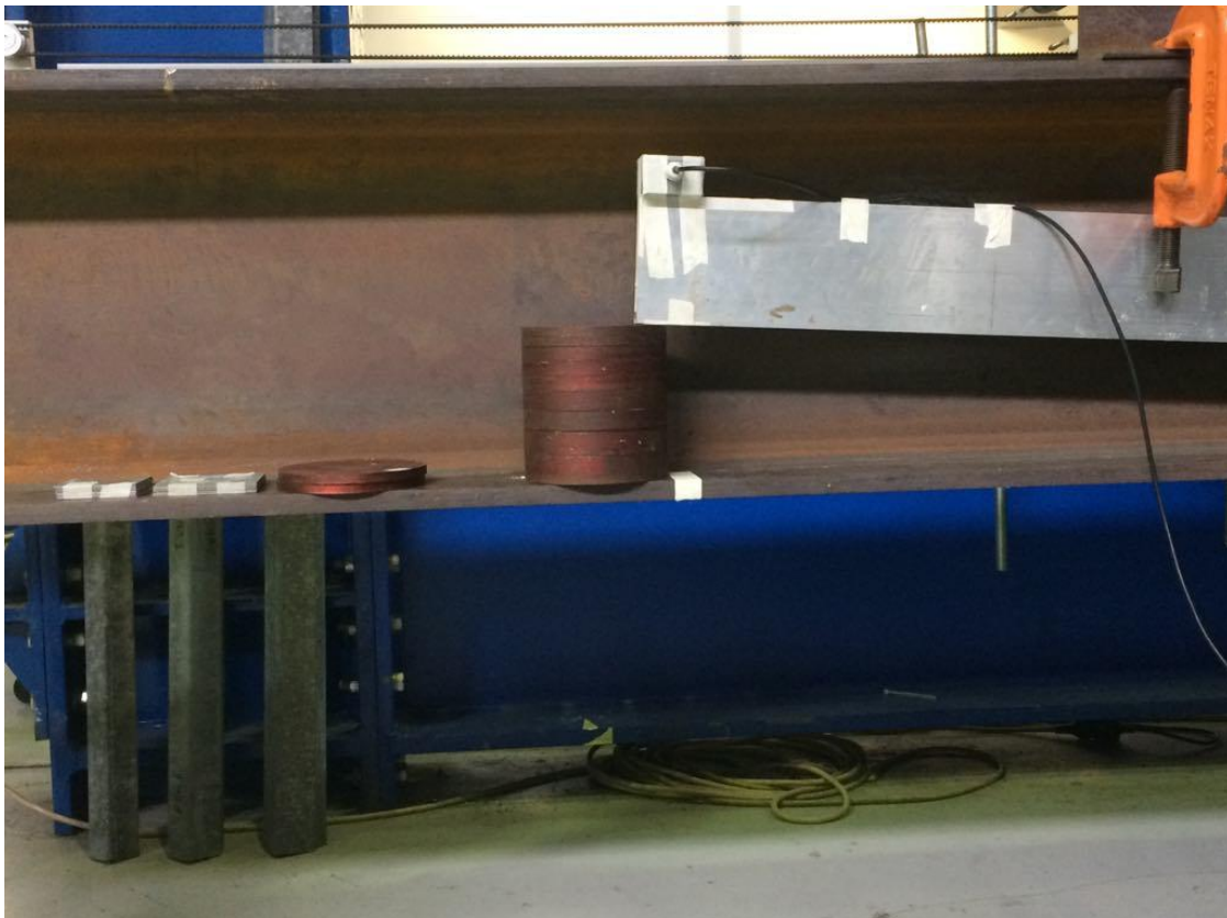
Εικόνα 5.1: Εικόνα από τη διαδικασία βαθμονόμησης περί τον άξονα X του κλινομέτρου
