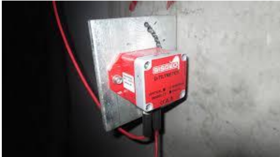
Εικόνα 2.2: Κλινόμετρο στερεωμένο σε πλάκα (πηγή: geotechpedia.com)
