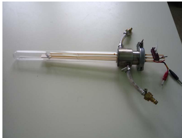
Εικόνα 5-23: Διάταξη σωλήνων αλούμινας εντός του σωλήνα χαλαζία.
