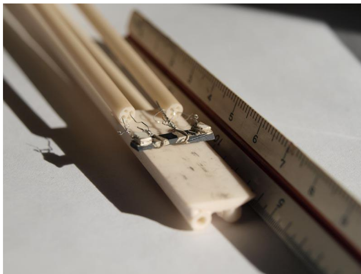
Εικόνα 5-17: Προσπάθεια παρασκευής δοκιμίου για μέτρηση ιοντικής αγωγιμότητας με την μέθοδο DC4P.
