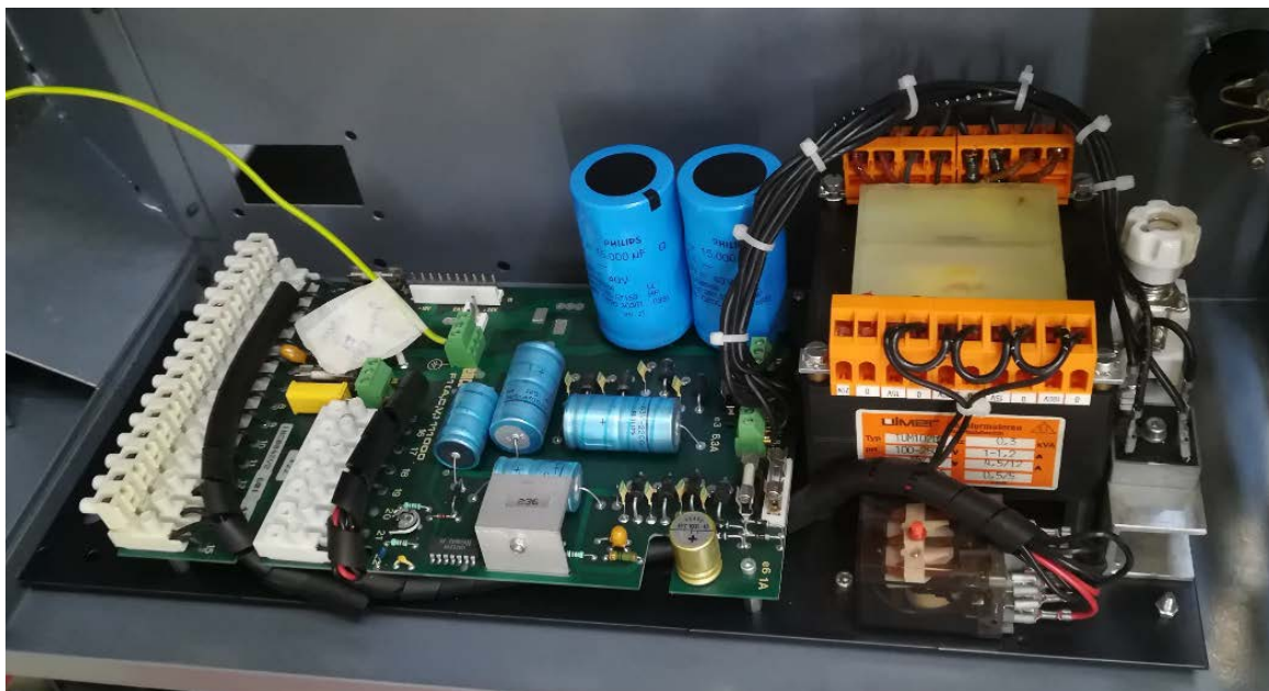
Εικόνα 6.8: Πλακέτα τροφοδοσίας πλακέτας ελέγχου DC κινητήρα της κύριας ατράκτου.
