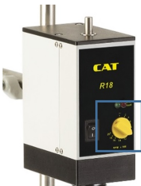
Εικόνα 9.2: Ηλεκτρικός αναδευτήρας. Εντός του μπλε τετραγώνου το τμήμα που σχεδιάστηκε και κατασκευάστηκε.
