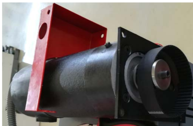
Εικόνα 3.9: Κινητήρας συνεχούς ρεύματος κυρίας ατράκτου. Διακρίνεται ο ιμάντας μετάδοσης κίνησης προς τον συγκρατητή κοπτικών εργαλείων.
