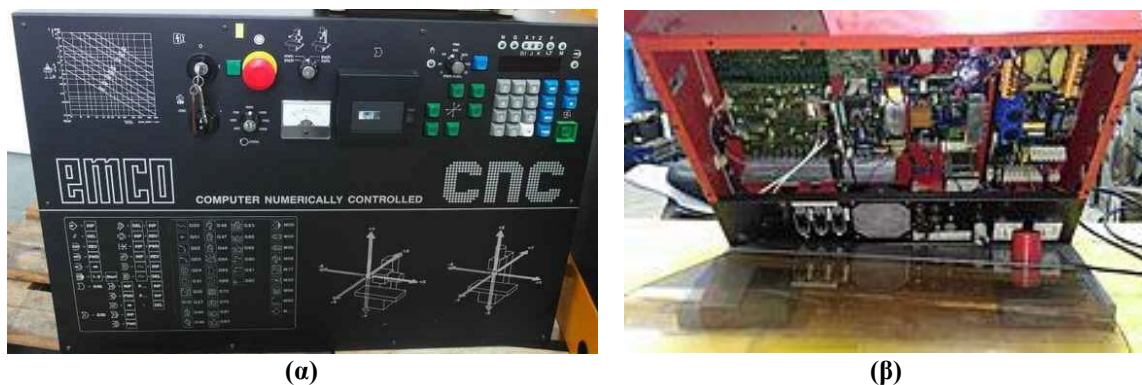
Εικόνα 3.12: Εμπρόσθια (α) και οπίσθια (β) άποψη του κέντρου ελέγχου.
