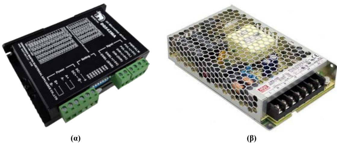
Εικόνα 5.2: (α) Οδηγός βηματικού κινητήρα και (β) τροφοδοτικό των οδηγών.
