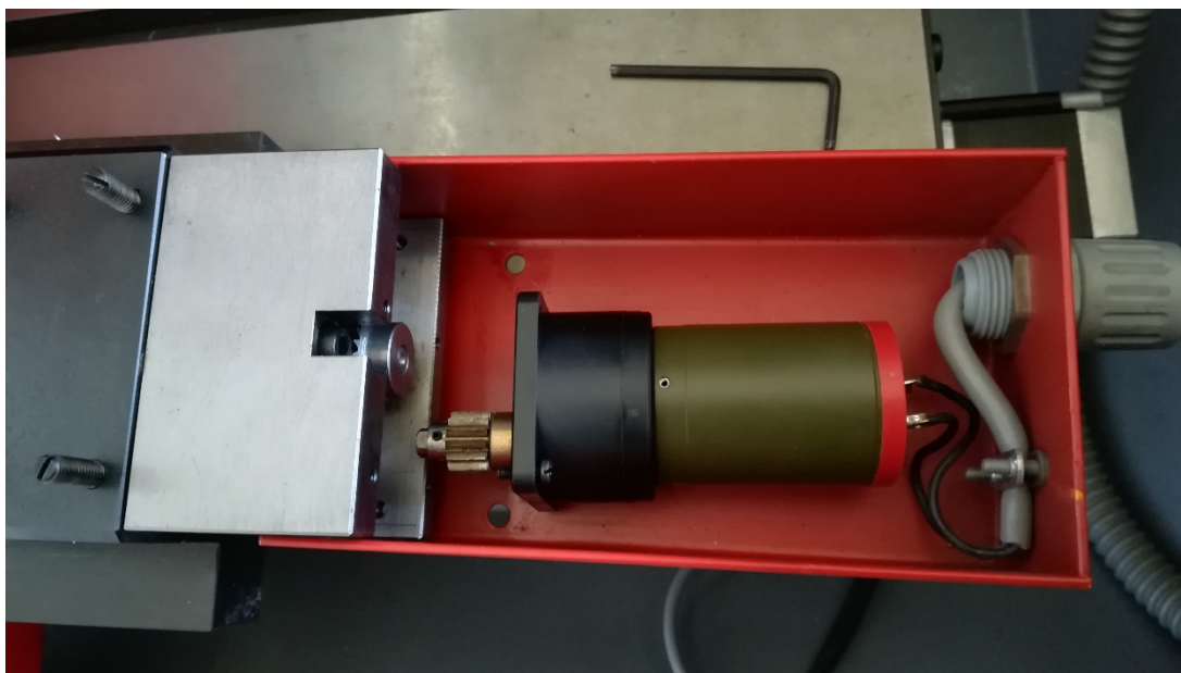
Εικόνα 7.3: Ο κινητήρας συνεχούς ρεύματος της ηλεκτρικής μέγγενης.
