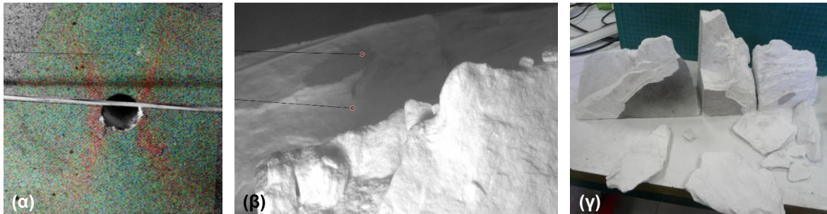
Σχήμα 7-75. Τελικό αποτέλεσμα της ανάλυσης DIC (α) σε ΦΜ με οπές διαμέτρου 10 mm της ποικιλίας «Βώλακας II» και φωτογραφία (β & γ) του αντίστοιχου ΦΜ μετά την ολοκλήρωση της δοκιμής θλίψης.
