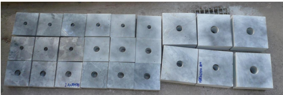
Σχήμα 7-2. Ενδεικτικά φυσικά μοντέλα έπειτα από τον ψεκασμό τους με υδαρό διάλυμα μαύρου χρώματος.
