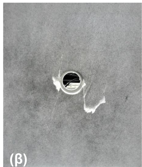
Σχήμα 7-60. Τελικό αποτέλεσμα της ανάλυσης DIC (α) σε ΦΜ με οπές διαμέτρου 35 mm της ποικιλίας «Βώλακας Άριστον Ι» και φωτογραφία (β) του αντίστοιχου ΦΜ μετά την ολοκλήρωση της δοκιμής θλίψης.
