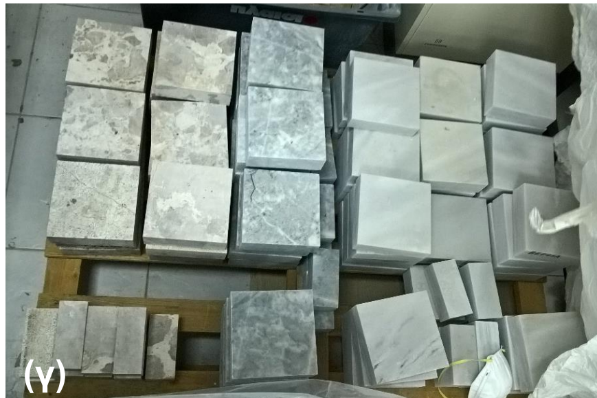
Σχήμα 7-1. Τα άρρηκτα δοκίμια που χρησιμοποιήθηκαν στην παρούσα διατριβή (α: «Βώλακας Άριστον Ι», β: «Βώλακας ΙΙ», γ (από αριστερά προς τα δεξιά): «Απόλλων», «Νεφέλη», «Βέροια»).
