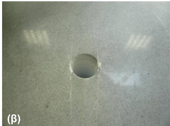
Σχήμα 7-59. Τελικό αποτέλεσμα της ανάλυσης DIC (α) σε ΦΜ με οπές διαμέτρου 22 mm της ποικιλίας «Βώλακας Άριστον Ι» και φωτογραφία (β) του αντίστοιχου ΦΜ μετά την ολοκλήρωση της δοκιμής θλίψης.
