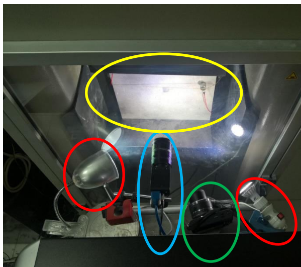
Σχήμα 4-5. Διάταξη DIC όπως εφαρμόστηκε κατά την παρούσα διατριβή σε ΦΜ. Με κόκκινα στοιχεία υποδεικνύονται τα φωτιστικά σώματα LED, με μπλε η κάμερα CCD, με πράσινο η κάμερα CMOS και με κίτρινο το φυσικό μοντέλο μαρμάρου ποικιλίας «Βώλακας Άριστον Ι».
