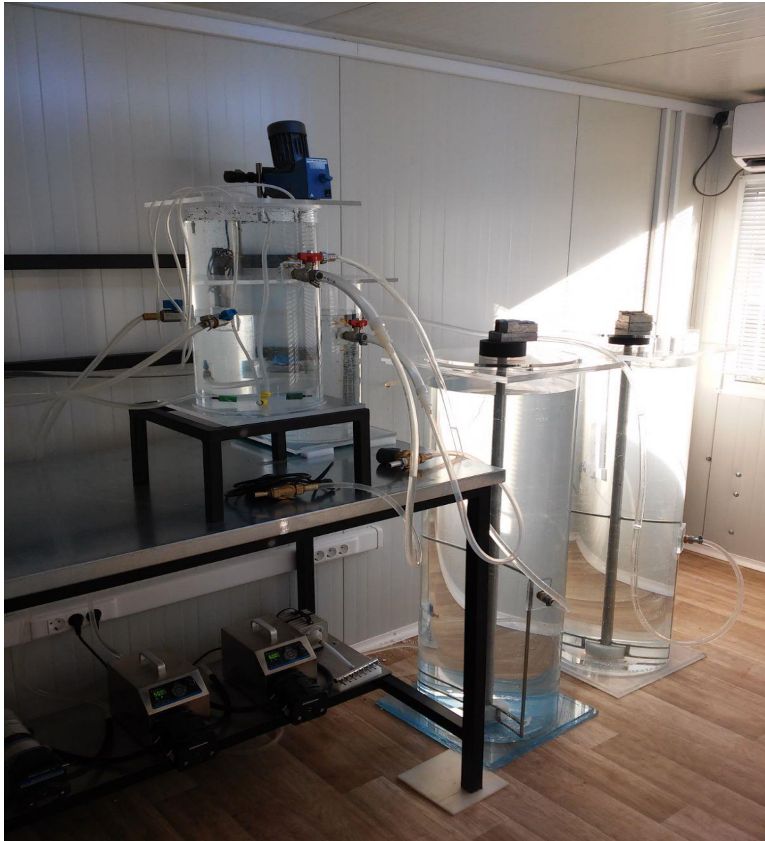
Εικόνα 3.1: Δεξαμενή επαφής HiCS (αριστερά) και Δεξαμενές Τελικής Καθίζησης (δεξιά) των δύο πιλοτικών συστημάτων – Αρχική τροφοδότηση με νερό
