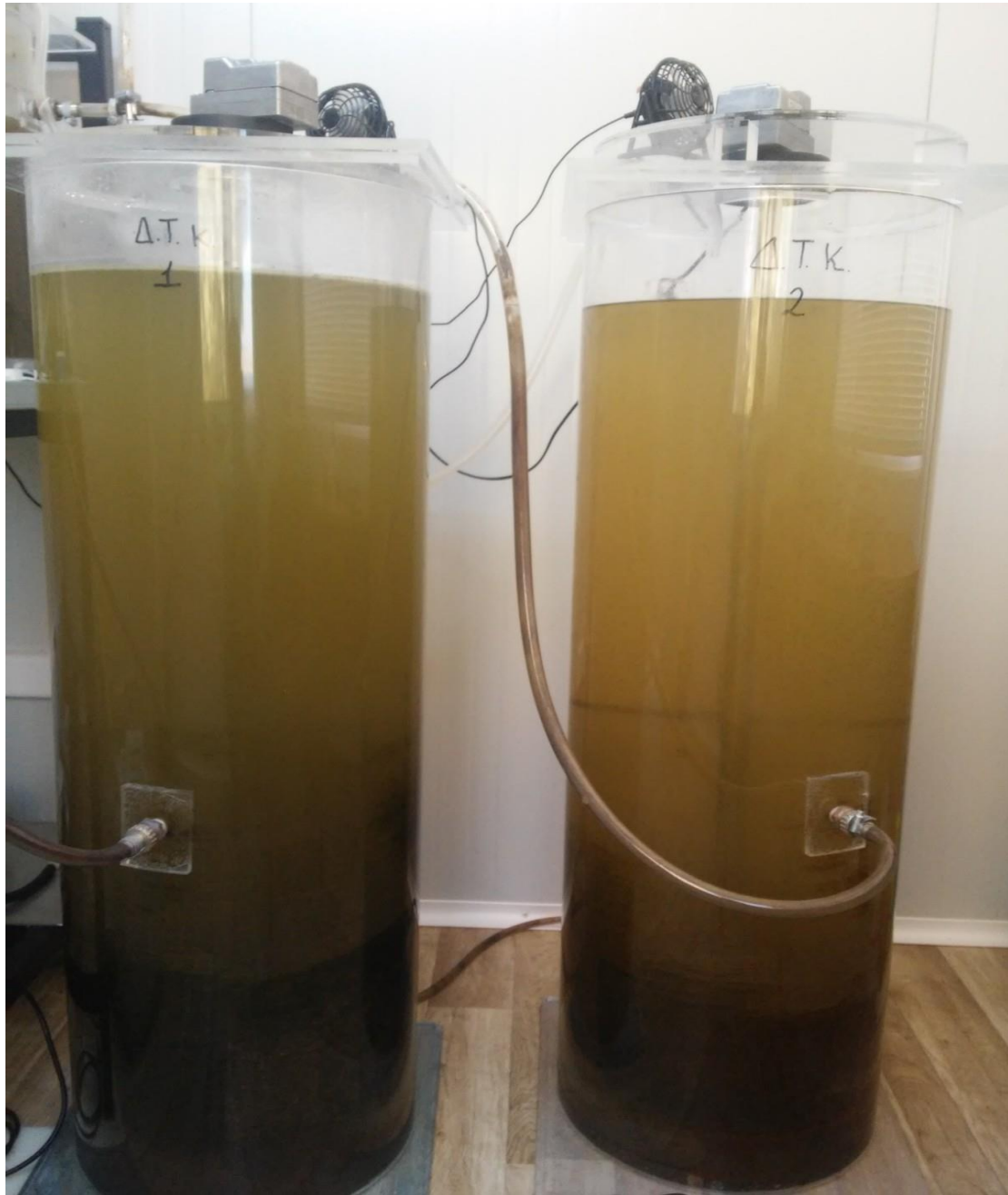
Εικόνα 3.4: Δεξαμενές Τελικής Καθίζησης HiCAS (αριστερά) και HiCS (δεξιά) – Λειτουργία με λύματα
