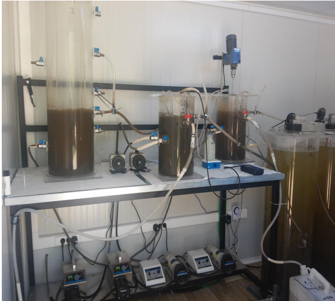
Εικόνα 3.5: Διάταξη των δεξαμενών των δύο πιλοτικών συστημάτων HiCAS και HiCS – Λειτουργία με λύματα
