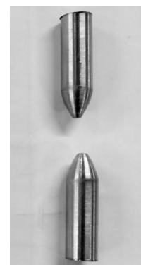
Εικόνα 5.2. Άνω και κάτω πέρους εφαρμογής για τη δοκιμασία εφελκυσμού
