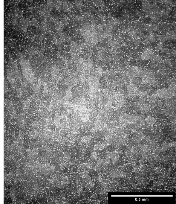
Εικόνα 6.5. Δείγμα Α - Βασικό μέταλλο αλουμινίου (Keller's) – Dark filter
