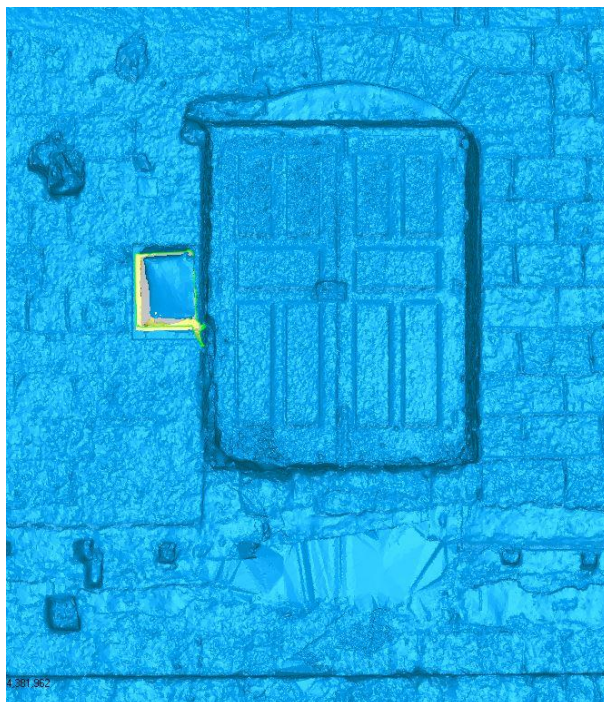
Εικόνα 4.30: Τμήμα της εισόδου του ναού μετά την εφαρμογή του Mesh Doctor
