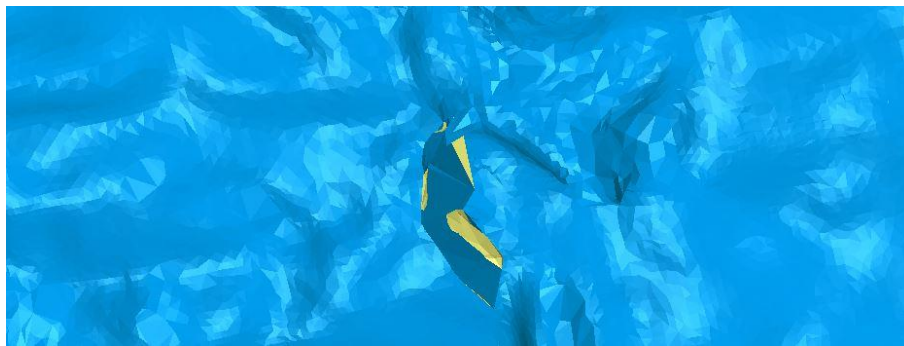
Εικόνα 4.24: Ανεστραμμένα τρίγωνα στην τρισδιάστατη επιφάνεια
