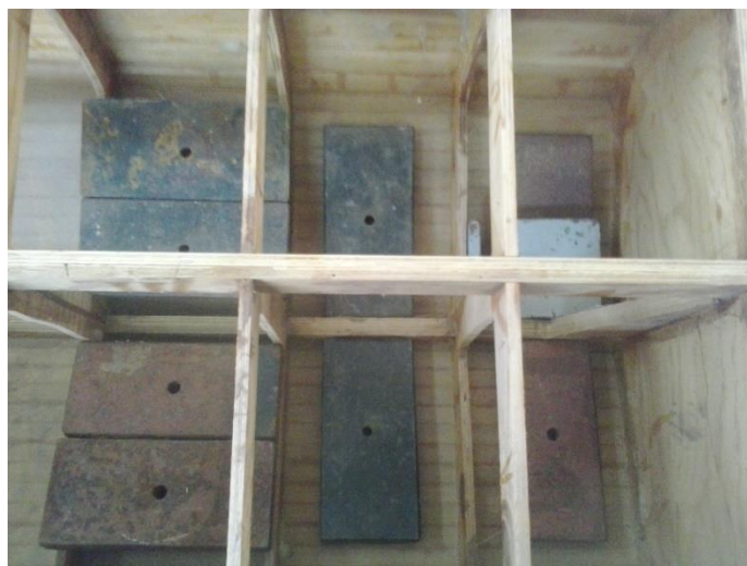
Εικόνα 4.2.3 Τοποθέτηση των βαρών στο σκάφος
