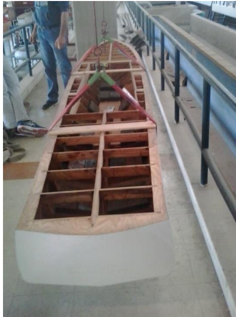
Εικόνα 4.2.4 Υπολογισμός ακτίνας αδρανείας του μοντέλου
