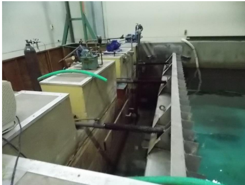
Εικόνα 4.1.4 Κυματοστήρας της πειραματικής δεξαμενής
