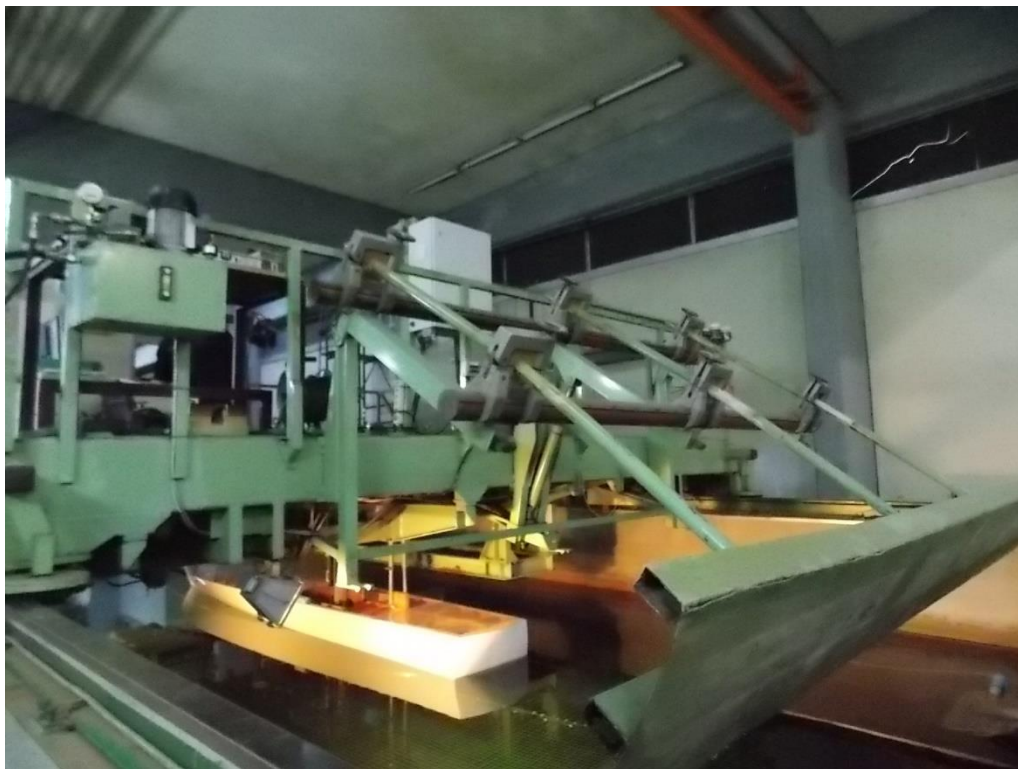
Εικόνα 4.1.5 Άποψη του φορείου της πειραματικής δεξαμενής με προσδεμένο το μοντέλο
