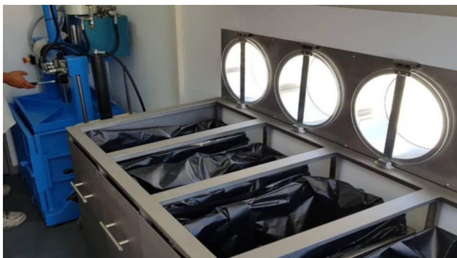
Εικόνα 16: Συμπιεστής δεματοποιητής των ανακυκλώσιμων υλικών μετά τον περαιτέρω διαχωρισμό
