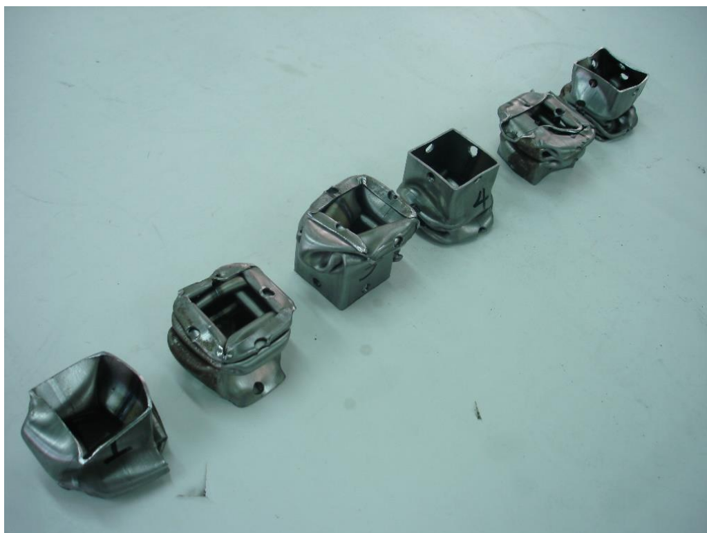
Σχήμα 4.9 Φωτογραφίες των δοκιμίων μετά την δυναμική φόρτιση.
