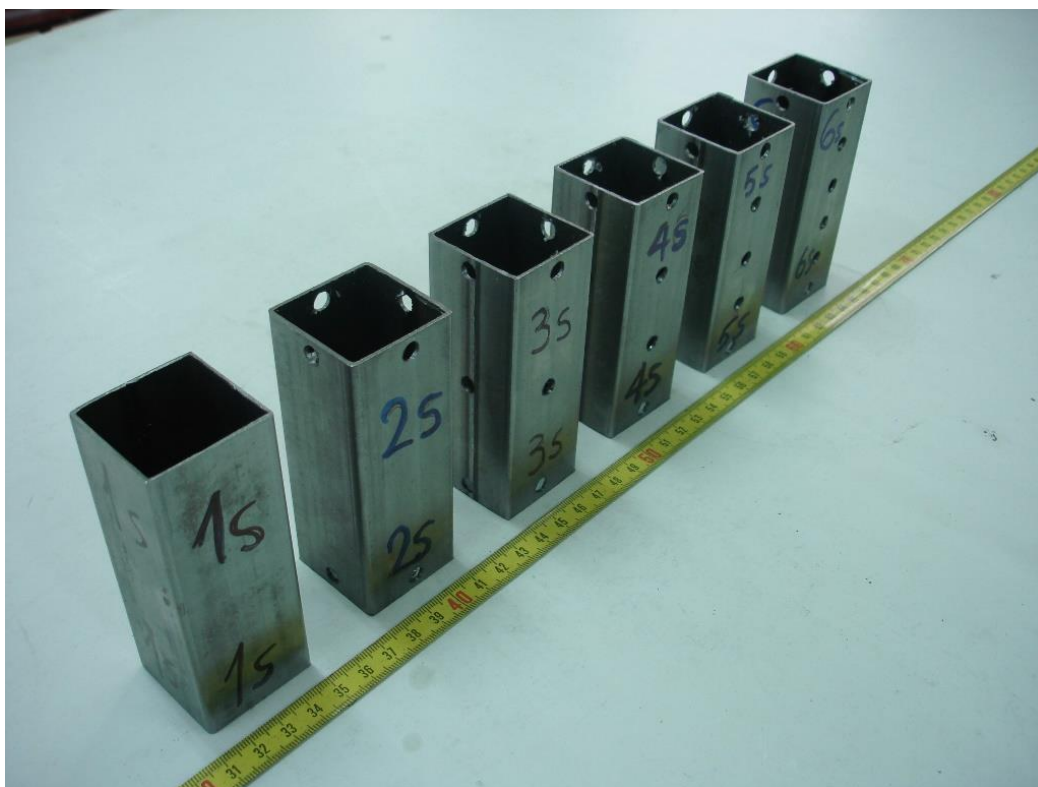
Σχήμα 4.6 Φωτογραφίες των δοκιμίων πριν την στατική φόρτιση.
