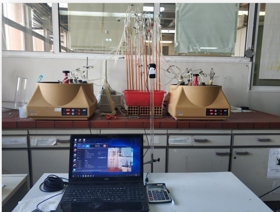
Εικόνα 2: Τελική πειραματική διάταξη μέτρησης παραγωγής βιοαερίου.
