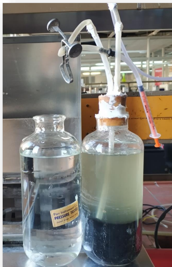
Εικόνα 1: Γυάλινο μπουκάλι που χρησιμοποιήθηκε ως αντιδραστήρας batch, πληρωμένο ως το 1/3 με ενεργή λάσπη.
