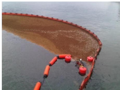
Εικόνα 2.26 Συνδυασμός δράσης booms και skimmers για τον περιορισμό και την απομάκρυνση πετρελαίου ( International Tanker Owners Pollution Federation (ITOPF), 2012 )
