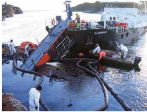
Εικόνα 2.25 Skimmer με ταινία προσαρμοσμένο σε ειδικό σκάφος. Η ταινία κατασκευασμένη από πλέγμα επιτρέπει στο νερό να διαφεύγει και στο πετρέλαιο να προσκολλάται σε αυτή. Το πετρέλαιο καταλήγει στο σκάφος και αποθηκεύεται στις δεξαμενές του ( International Tanker Owners Pollution Federation (ITOPF), 2012 )
