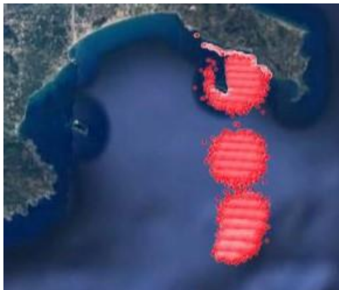
Εικόνα 7.17 Συνολική μετατόπιση πετρελαιοκηλίδας 48 ώρες μετά τη διαρροή (υπέρθεση των στιγμιότυπων ανά 3 ώρες) (MEDSLIK)
