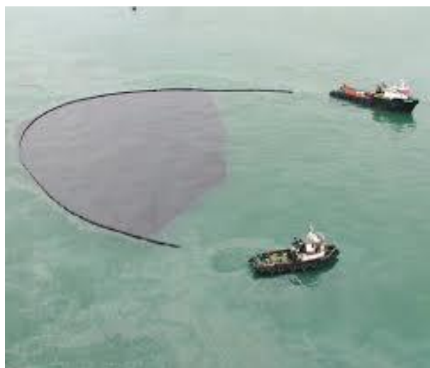
Εικόνα 2.24 Φουσκωτά booms που έχουν αναπτυχθεί σε σχήμα U μεταξύ δύο σκαφών για τον περιορισμό πετρελαιοκηλίδας αργού πετρελαίου ( International Tanker Owners Pollution Federation (ITOPF), 2011 )
