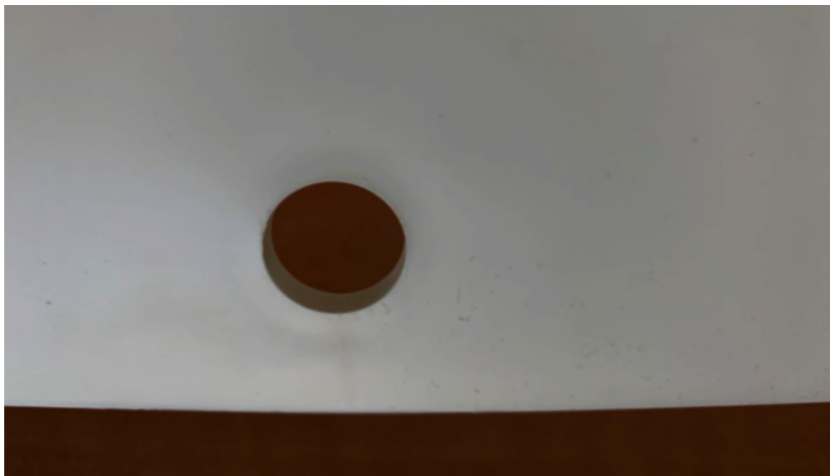
Σχήμα 4-4. Γραμμές συγκόλλησης (weld lines) σε περιοχές του πραγματικού προϊόντος έγχυσης όπου το μέτωπο ροής «σπάει» σε επιμέρους μέτωπα.
