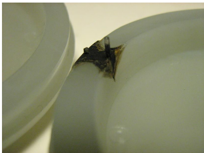
Σχήμα 3-8. Σημάδια καύσης (burn marks) στην εξωτερική επιφάνεια ενός παραχθέντος προϊόντος έγχυσης.
