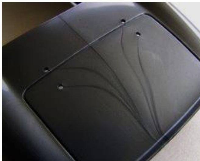
Σχήμα 3-5. Γραμμές ροής (flow lines) στην εξωτερική επιφάνεια ενός παραχθέντος προϊόντος έγχυσης.
