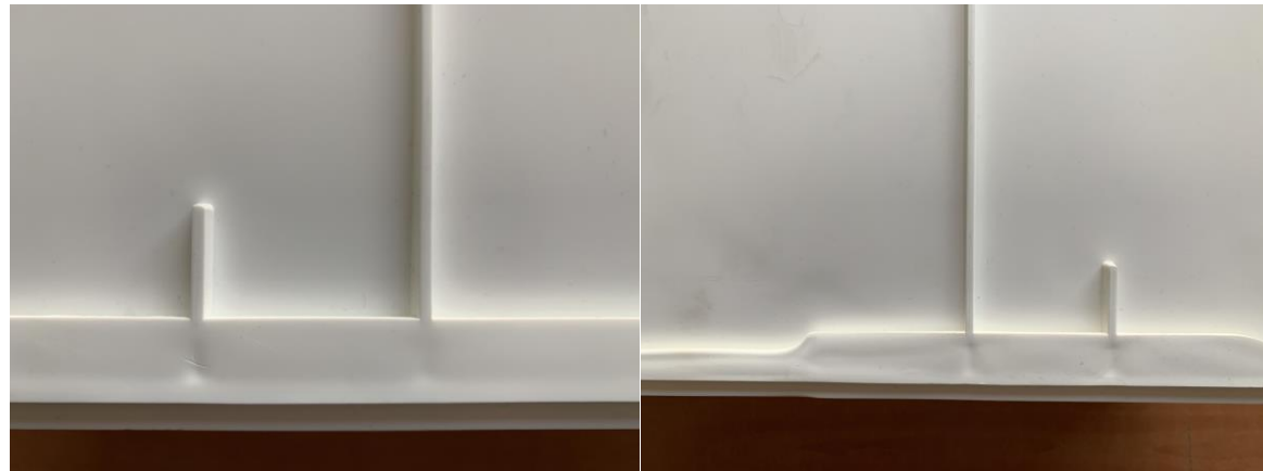
Σχήμα 4-5. Βαθουλώματα (sink marks) σε περιοχές του πραγματικού προϊόντος έγχυσης με αυξημένο πάχος (π.χ. νεύρα στήριξης).
