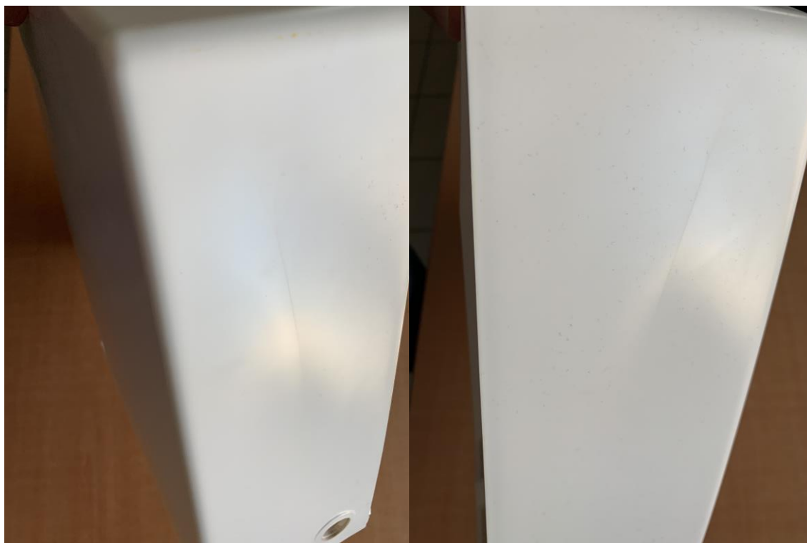
Σχήμα 4-6. Γραμμές ροής (flow lines) σε περιοχές του πραγματικού προϊόντος έγχυσης όπου τα επιμέρους μέτωπα ροής συγχωνεύονται.
