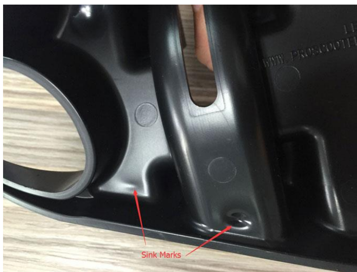
Σχήμα 3-7. Βαθουλώματα (sink marks) στην εξωτερική επιφάνεια ενός παραχθέντος προϊόντος έγχυσης.
