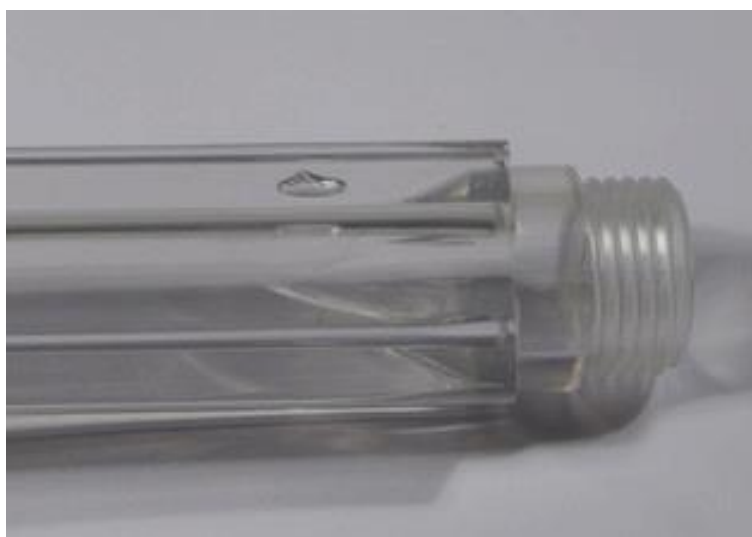
Σχήμα 3-9. Διαφανές προϊόν έγχυσης στα εσώτερα στρώματα της εξωτερικής επιφάνειας του οποίου έχει σχηματιστεί κενό λόγω παγιδευμένου αέρα.
