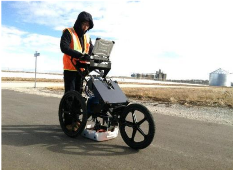
Εικόνα 2.6: Παράδειγμα σύγχρονου γεωραντάρ, GSSI GPR (900MHz,SIR-20 DATA ACQUISITION SYSTEM) (Hu , 2015).
