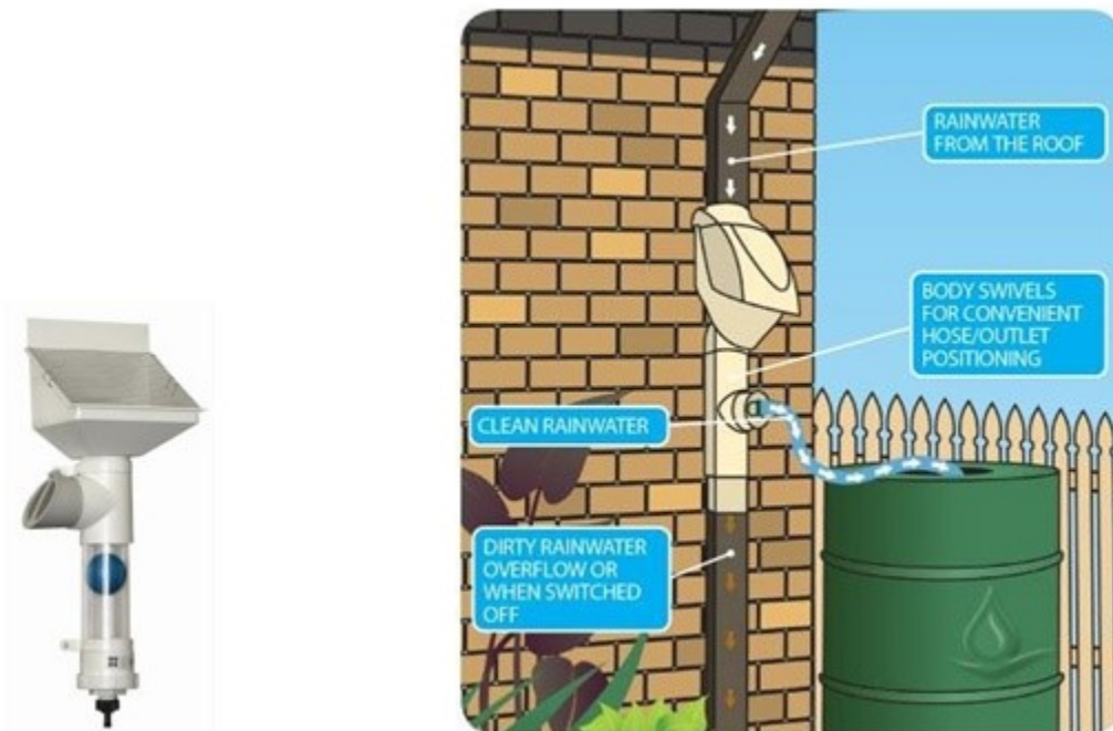
Σχήμα 3.3 Φίλτρο και εκτροπή της πρώτης έκπλυσης σε συστήματα συλλογής όμβριων υδάτων (Πηγή: aquabarrel.com )
