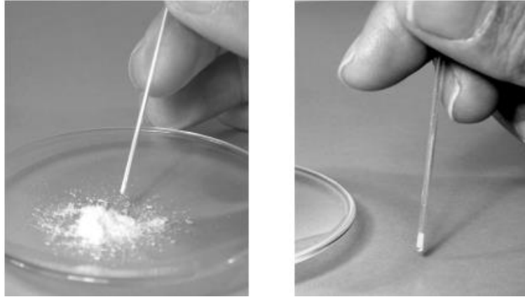
Εικόνα 25 Δειγματοληψία και πάκτωση σε τριχοειδή σωλήνα
