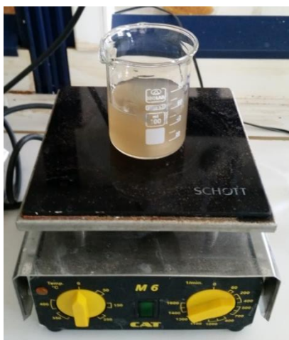
Εικόνα 30 Αραιωμένο ανάμικτο υγρό υπό ανάδευση
