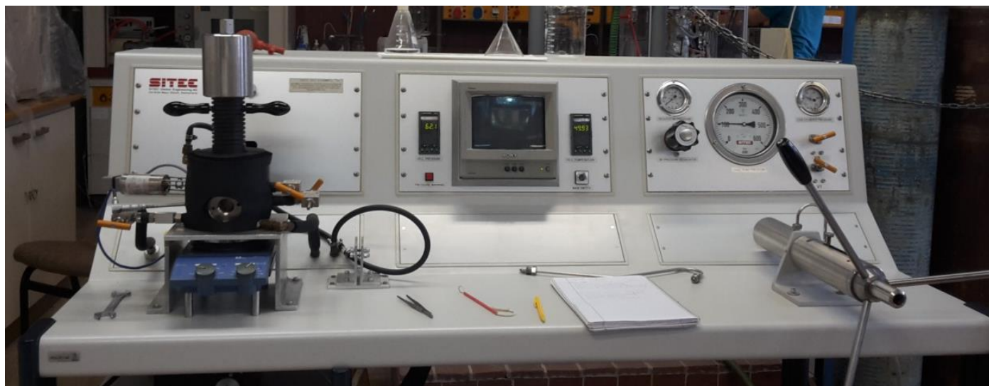
Εικόνα 41 Διάταξη απορρόφησης CO 2
