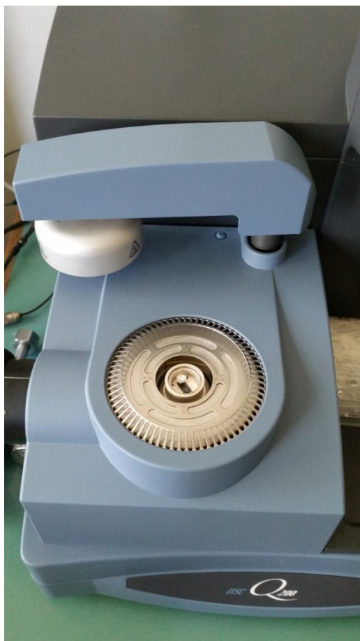
Εικόνα 28 Συσκευή διαφορικής θερμιδομετρίας σάρωσης Q200
