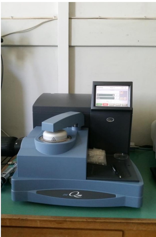
Εικόνα 28 Συσκευή διαφορικής θερμιδομετρίας σάρωσης Q200
