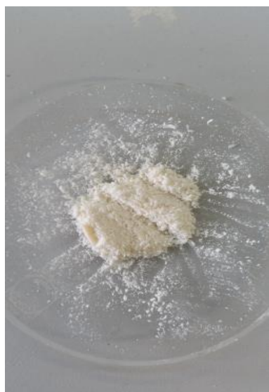
Εικόνα 39 Λειοτριβημένα στερεά ιοντικά υγρά για μέτρηση σημείου τήξης
