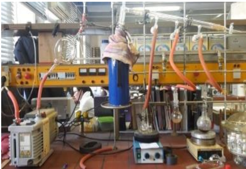
Εικόνα 22 Αντλία υπό κενό και προσθήκη ανάδευσης με θέρμανση
