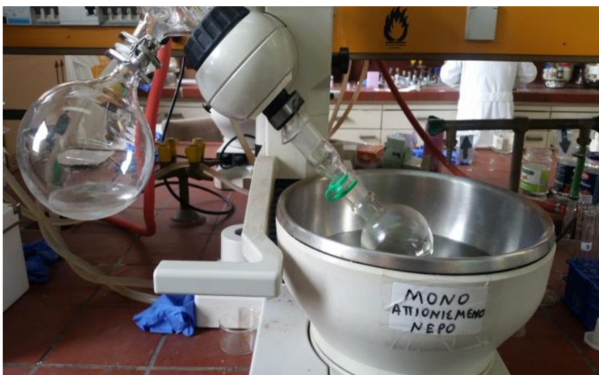
Εικόνα 21 Περιστροφική εξάτμιση για απομάκρυνση διαλύτη αιθανόλη
