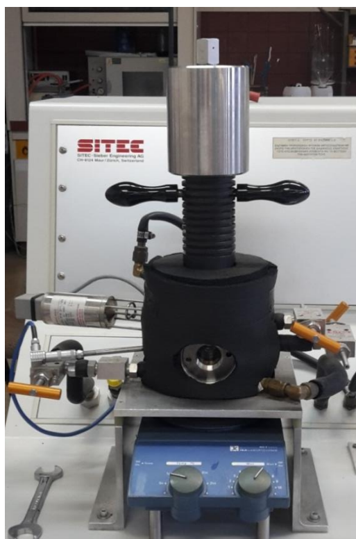
Εικόνα 42 Κελί εισαγωγής δείγματος και διοχέτευσης CO 2
