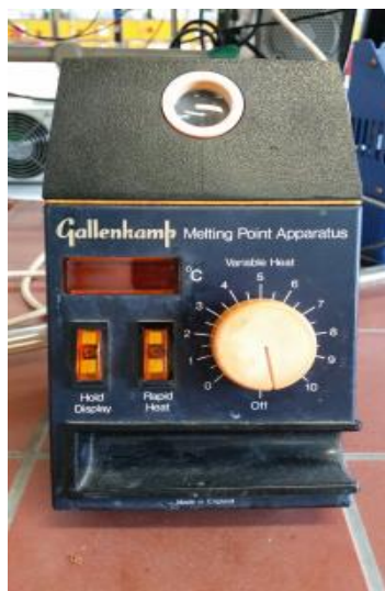
Εικόνα 27 Melting Point Apparatus και γυάλινος κύλινδρος
