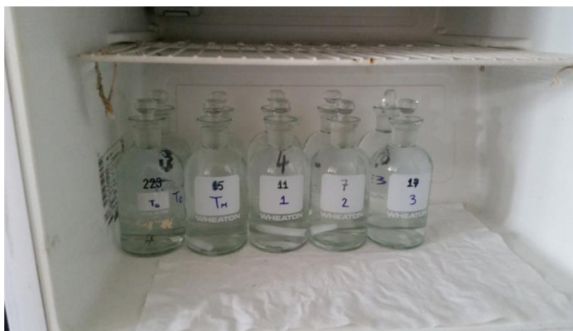
Εικόνα 31 Μπουκάλια σε ψυγείο θερμοκρασίας 20±1°C
