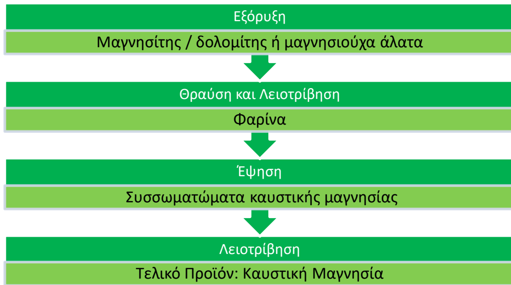
Σχήμα 4. 1: Διάγραμμα ροής της παραγωγικής διαδικασίας της καυστικής μαγνησίας.
