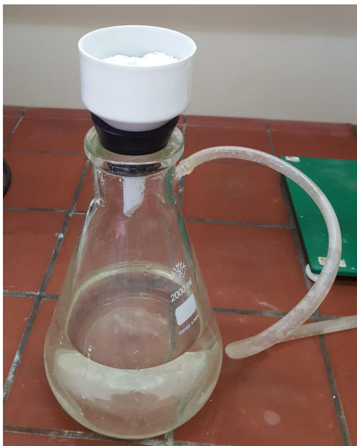
Εικόνα 5. 13: Διάταξη διήθησης υδατικού διαλύματος
