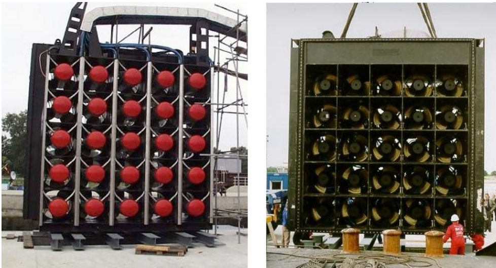
Σχήμα 3.3: Οι δυο όψεις ενός πλέγματος στροβιλογεννητριών. Δεξιά είναι η όψη κατάντι του φράγματος, ενώ αριστερά φαίνονται οι ενσωματωμένες γεννήτριες. (πηγή: Andritz AG )
