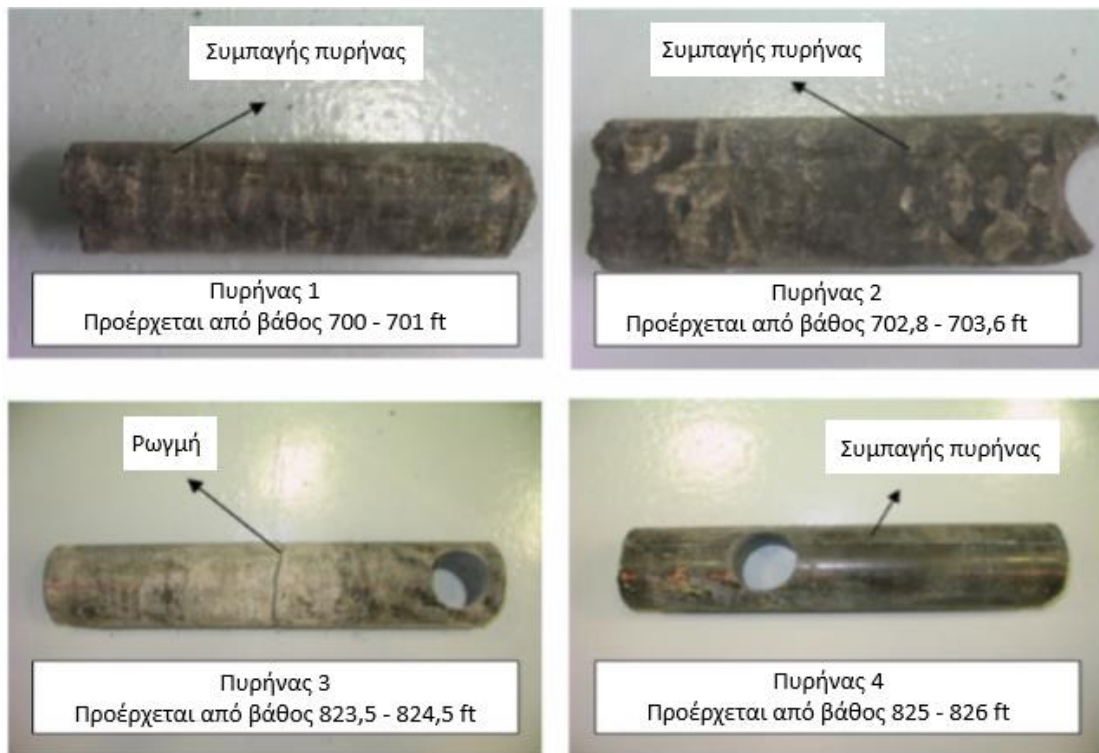
Εικόνα 3-18. Δείγματα πυρήνων από σχηματισμούς ενδιαφέροντος που εντοπίζονται σε διαφορετικά βάθη, σε γεώτρηση που έχει ορυχθεί στο Κουβέιτ (Al-Omair, 2008)
