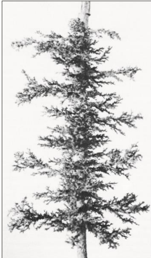
Εικόνα 3-20. Σχηματισμός διόδων (wormholes) σε δείγμα ανθρακικού σχηματισμού κατά την εισπίεση οξέων για την αύξηση της διαπερατότητάς του, σε εργαστηριακή κλίμακα. Το μήκος, η διεύθυνση και ο αριθμός των διόδων εξαρτάται από την αντιδραστικότητα του σχηματισμού και τον ρυθμό εισπίεσης, με τον οποίο τα οξέα διεισδύουν στον σχηματισμό. Όταν σχηματιστούν τέτοιες δίοδοι, μέσω αυτών ρέουν πρακτικά όλοι οι υδρογονάνθρακες προς την γεώτρηση και από εκεί στην επιφάνεια (DeBryjijn, και συν., 2008)
