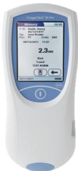
Εικόνα 1.2: Συσκευή CoaguChek XS Pro system από την Roche Diagnostics για τη μέτρηση του INR
