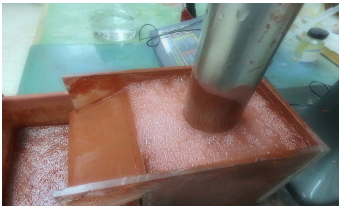
Εικόνα 9: Ψιλομερής αφρός, ανοικτού κόκκινου χρώματος κατά την επίπλευση αιματίτη
