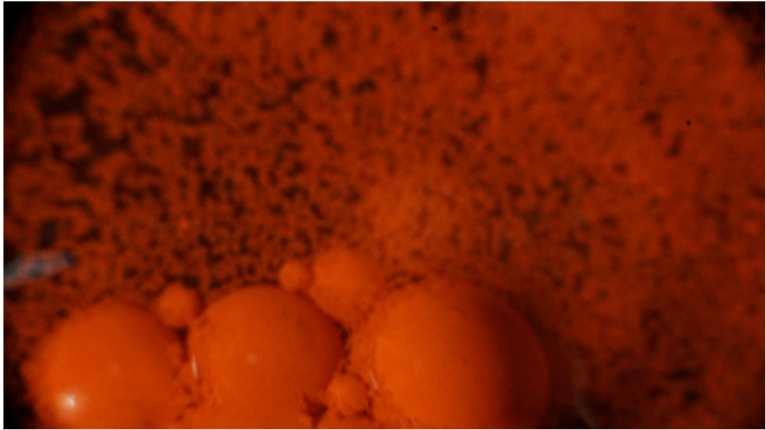
Εικόνα 10: Μικροσκοπική παρατήρηση συσσωματωμένων τεμαχιδίων αιματίτη μετά την επίπλευση – Φυσαλίδες αέρα καλυμμένες από τεμαχίδια αιματίτη
