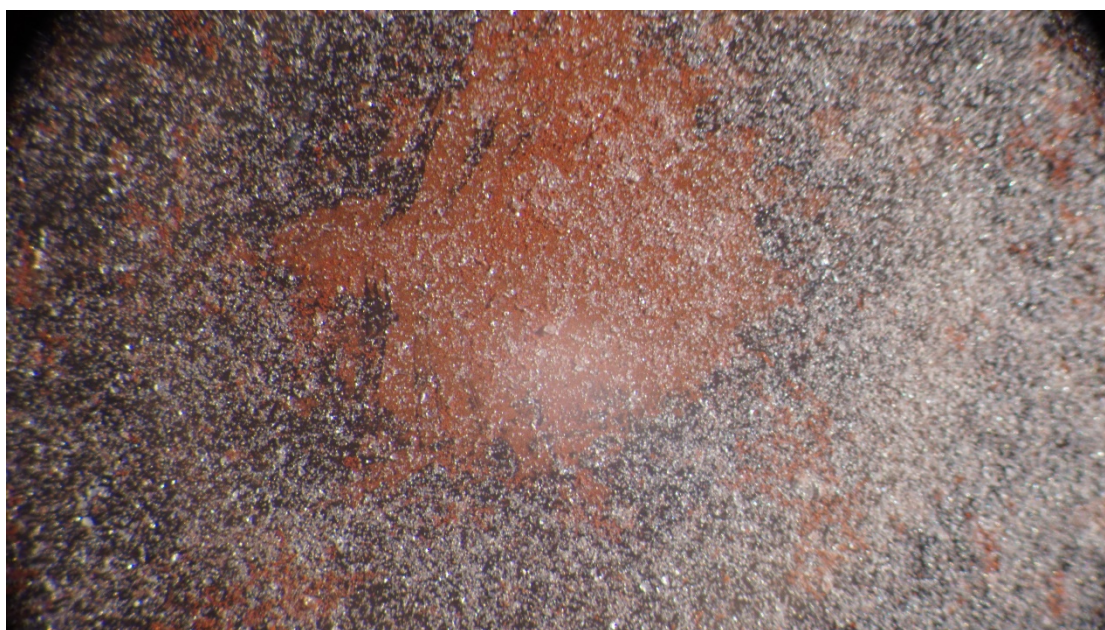
Εικόνα 15: Μικροσκοπική παρατήρηση μετά από επίπλευση μικτής τροφοδοσίας – Συσσωματώματα αιματίτη και μεμονωμένα τεμαχίδια χαλαζία
