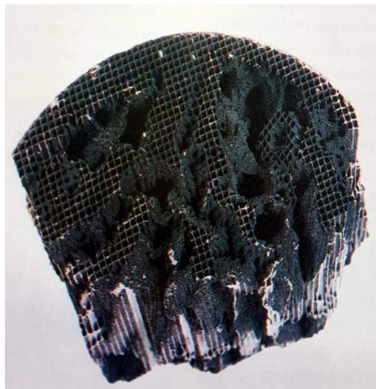
ΣΧΗΜΑ 28: Θερμικές οπές σε κεραμικό φορέα.[4]
