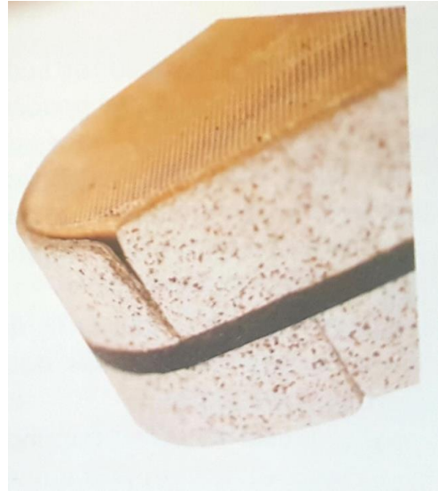
ΣΧΗΜΑ 7: Ημιαστικό σύνθετο υλικό. [4]
