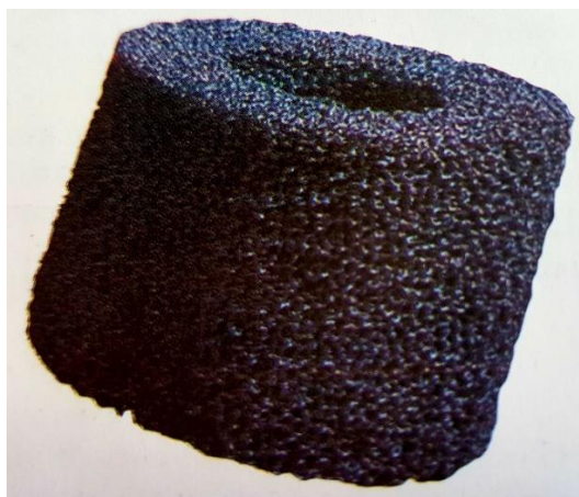
ΣΧΗΜΑ 11:Κεραμικός Μονόλιθος από SiC, κατασκευασμένος από την Ultramet.[4]
