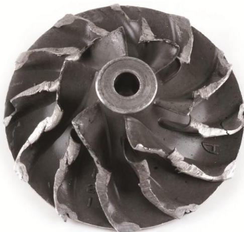
Εικόνα 12. Αυξημένες φθορές στα πτερύγια στροφείου πιθανώς από είσοδο αντικειμένου ή λόγω τριβών με το κάλυμμα (25)
