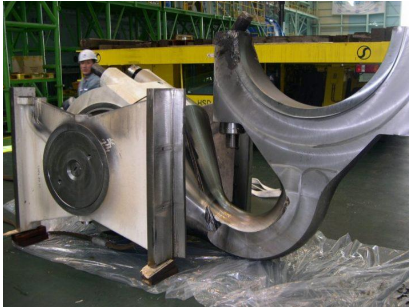
Εικόνα 9. Λυγισμός διωστήρα μεγάλου ναυτικού κινητήρα (17)
