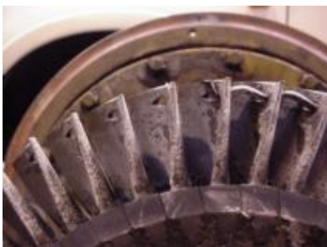
Εικόνες 13 και 14. Αριστερά κατεστραμμένο καλώδιο απόσβεσης ταλαντώσεων αξονικού στροβίλου μαζί με φθαρμένα πτερύγια και δεξιά κατεστραμμένο δαχτυλίδι στροβίλου (28).
