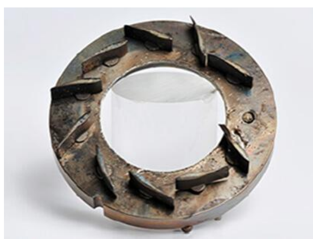
Εικόνες 13 και 14. Αριστερά κατεστραμμένο καλώδιο απόσβεσης ταλαντώσεων αξονικού στροβίλου μαζί με φθαρμένα πτερύγια και δεξιά κατεστραμμένο δαχτυλίδι στροβίλου (28).
