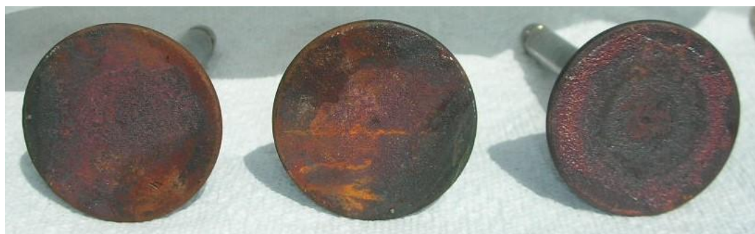
Εικόνα 10. Βαλβίδες εξαγωγής μετά από αρκετές ώρες χρήσης (21)
