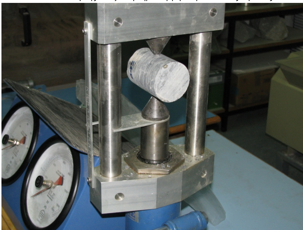
Εικόνα 5.59 Δολομίτης σε διαμετρική σημειακή φόρτιση παράλληλα στις στρώσεις του.
