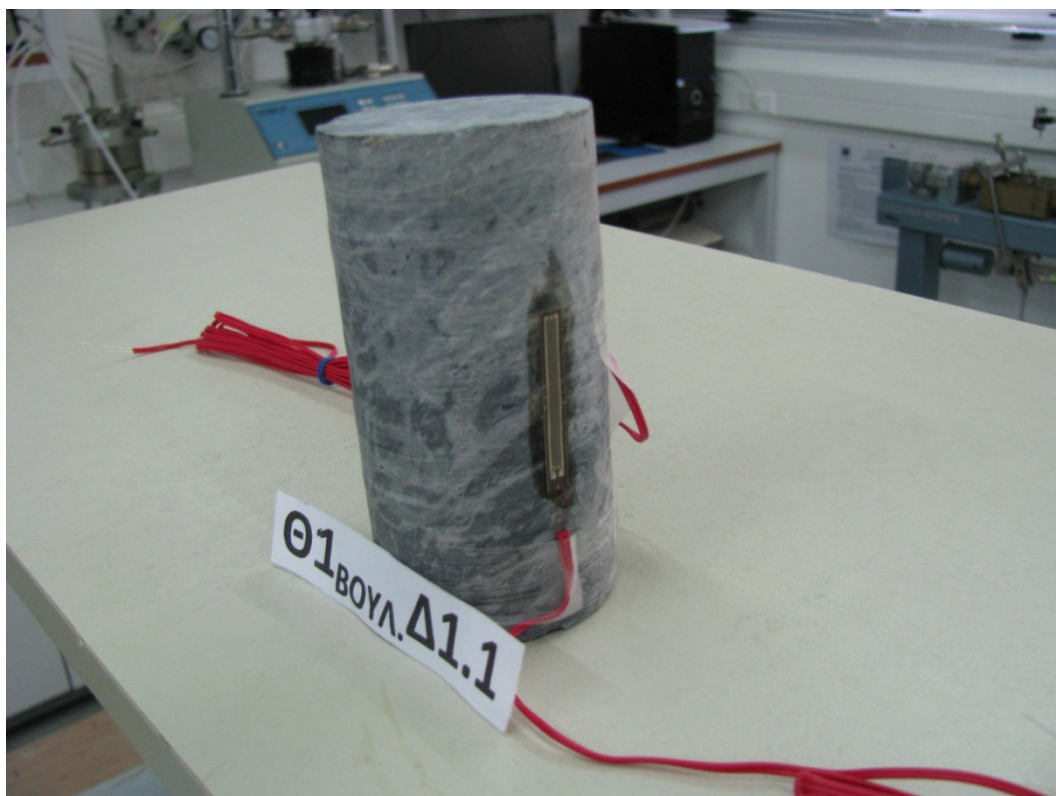
Εικόνα 5.62 Μετρητής κάθετης ελαστικής παραμόρφωσης.
