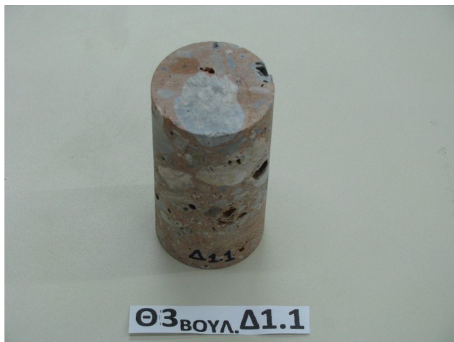
Εικόνα 5.12 Κυλινδρικό δοκίμιο κροκαλοπαγούς για μονοαξονική θλίψη.
