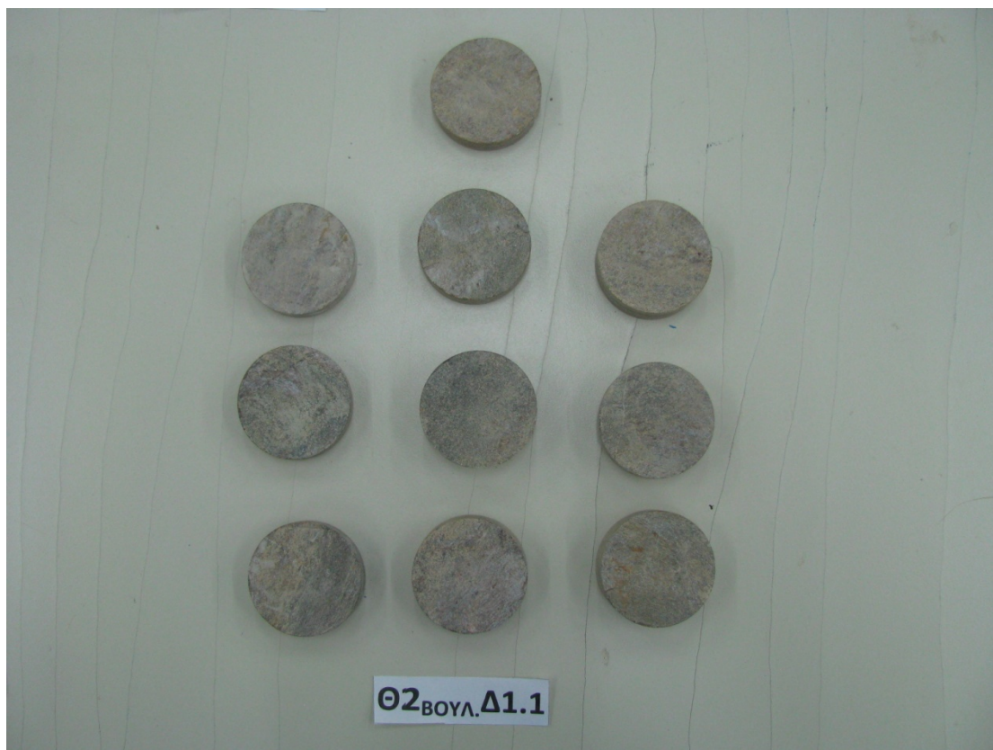
Εικόνα 5.77 Δοκίμια σχιστολίθου Βάρης για δοκιμή θραύσης κατά γενέτειρα (Brazilian).
