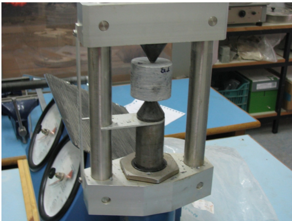
Εικόνα 3.10 Αξονική σημειακή φόρτιση δοκιμίου.
