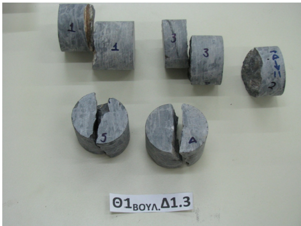
Εικόνα 5.60 Οι δολομίτες μετά την σημειακή φόρτιση.
