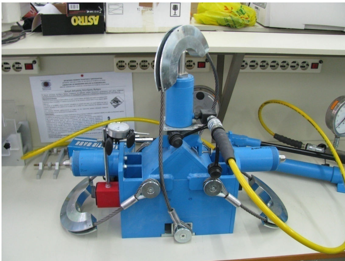
Εικόνα 3.13 Φορητή συσκευή για την εκτέλεση δοκιμής απευθείας διάτμησης (Field Shear Box, μοντέλο WF 40900).
