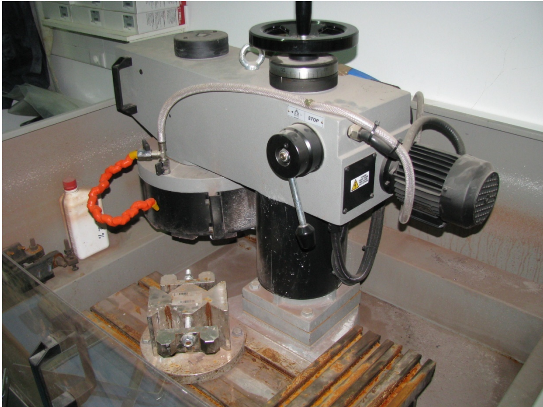
Εικόνα 3.3 Η μηχανή λείανσης πετρωμάτων του εργαστηρίου Τεχνικής Γεωλογίας.
