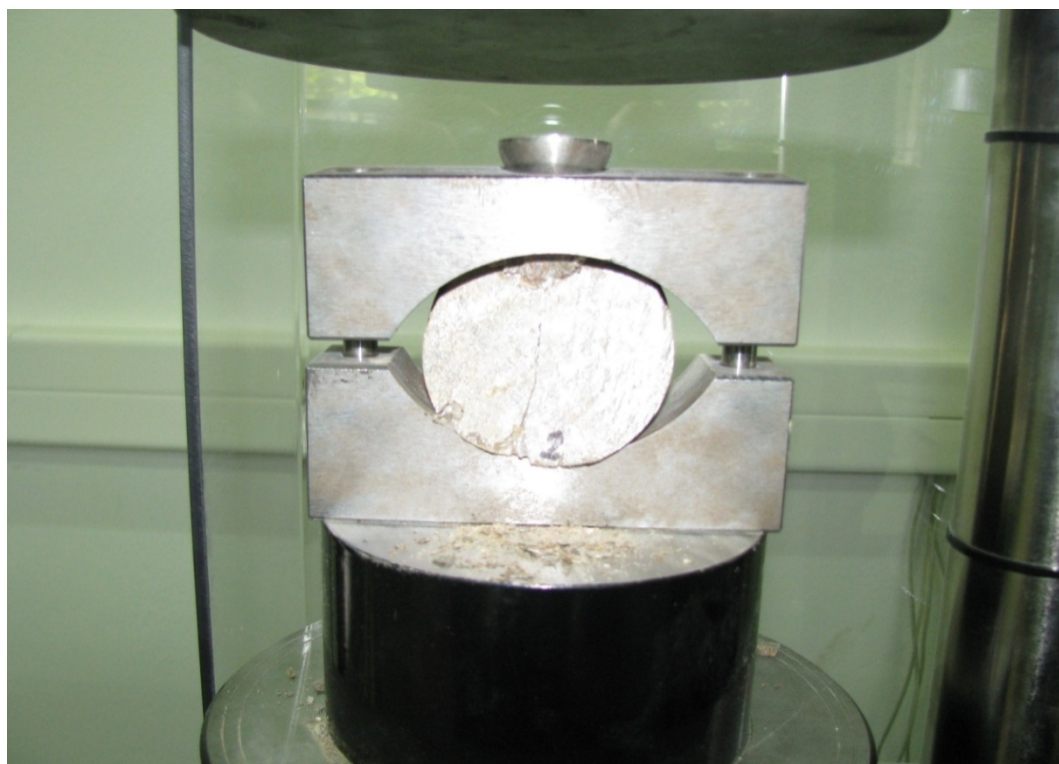
Εικόνα 5.55 Δολομίτης στη θραύση κατά γενέτειρα (Brazilian).
