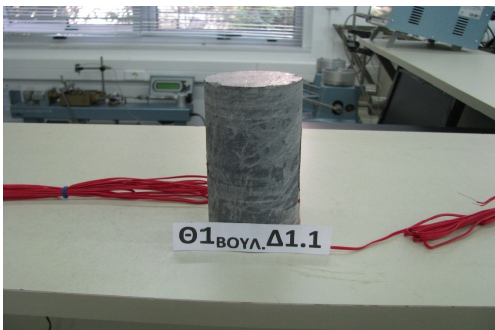
Εικόνα 5.61 Κυλινδρικό δοκίμιο δολομίτη με προσαρμοσμένους τους μετρητές ελαστικής παραμόρφωσης.
