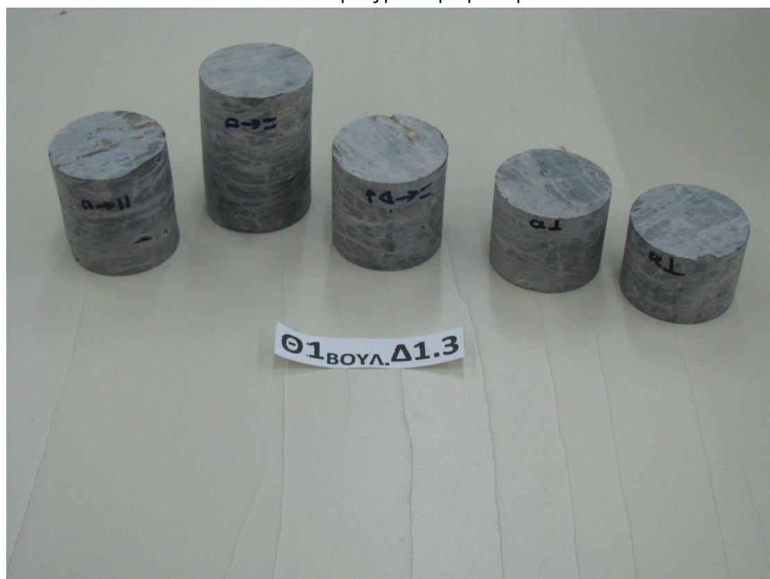
Εικόνα 5.57 Κυλινδρικά δοκίμια δολομίτη για δοκιμή σημειακής φόρτισης (PLT).
