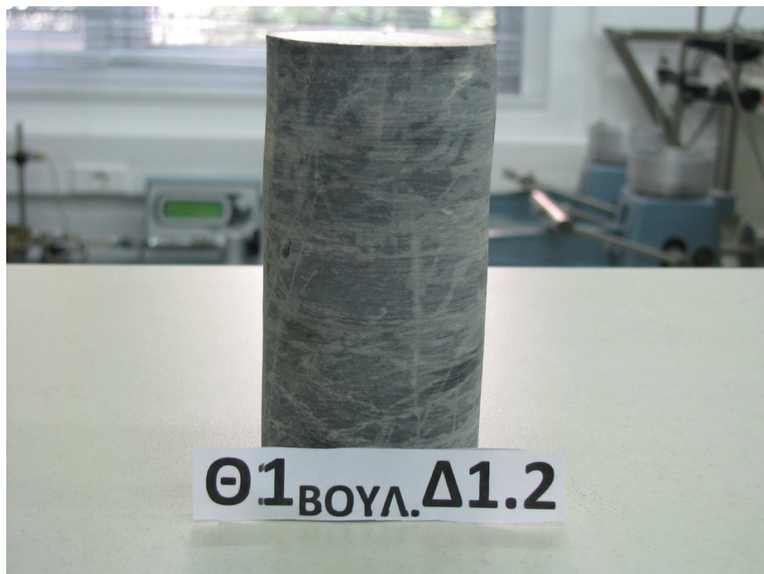
Εικόνα 5.66 Κυλινδρικό δοκίμιο δολομίτη διαμορφωμένο για την εκτέλεση δοκιμών προσδιορισμού αντοχής σε ανεμπόδιστη θλίψη.
