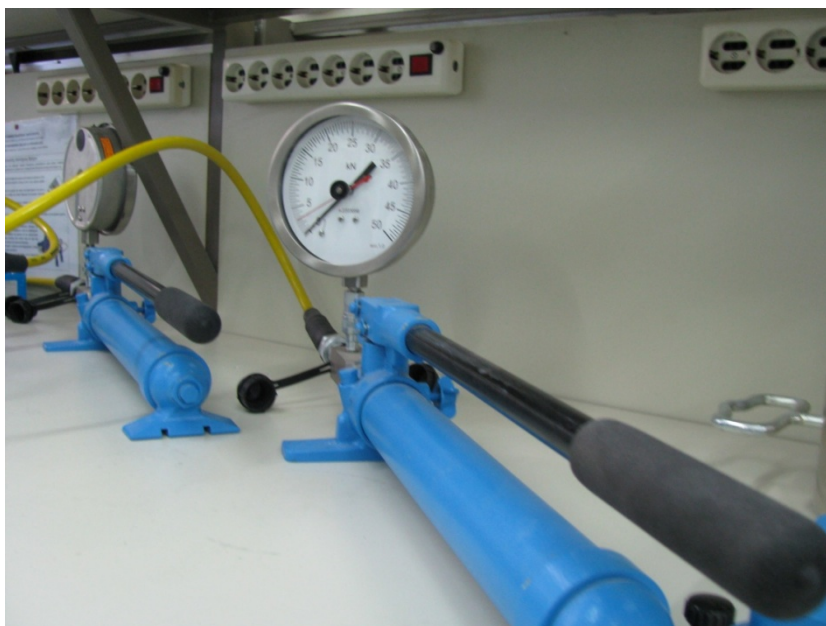
Εικόνα 3.15 Το σύστημα επιβολής ορθής και διατμητικής δύναμης.
