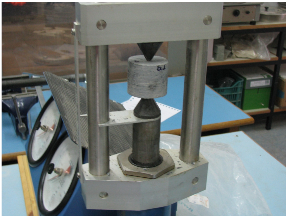
Εικόνα 5.58 Δολομίτης σε αξονική σημειακή φόρτιση κάθετα στις στρώσεις του.
