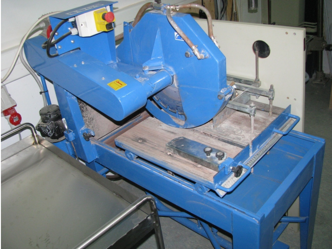
Εικόνα 3.2 Ο τραπεζοκόπτης βραχωδών δειγμάτων του εργαστηρίου Τεχνικής Γεωλογίας.
