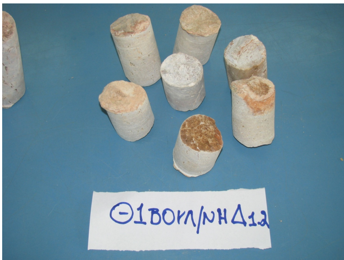
Εικόνα 5.33 Τα κυλινδρικά δοκίμια τραβερτίνη για την δοκιμή σημειακής φόρτισης.
