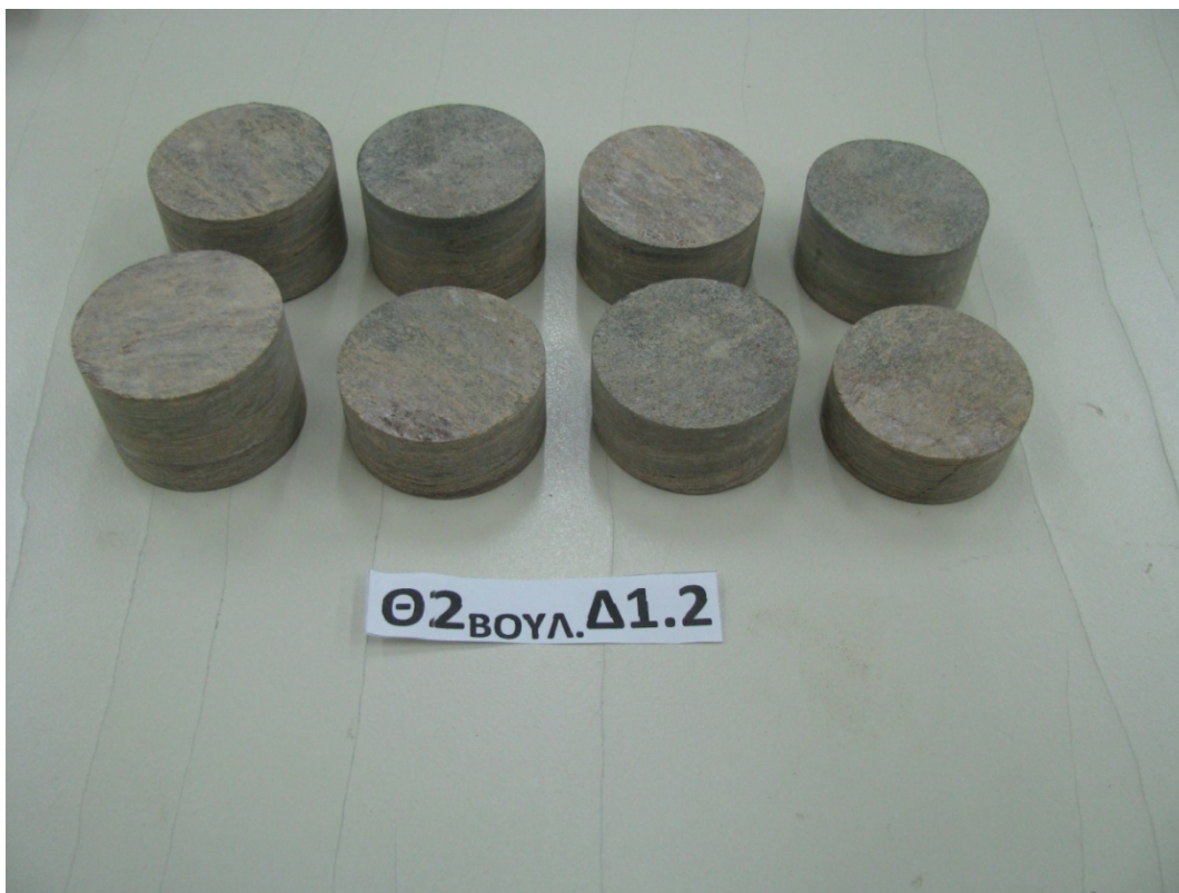
Εικόνα 5.75 Τα δοκίμια σχιστολίθου για την δοκιμή σημειακής φόρτισης (PLT).
