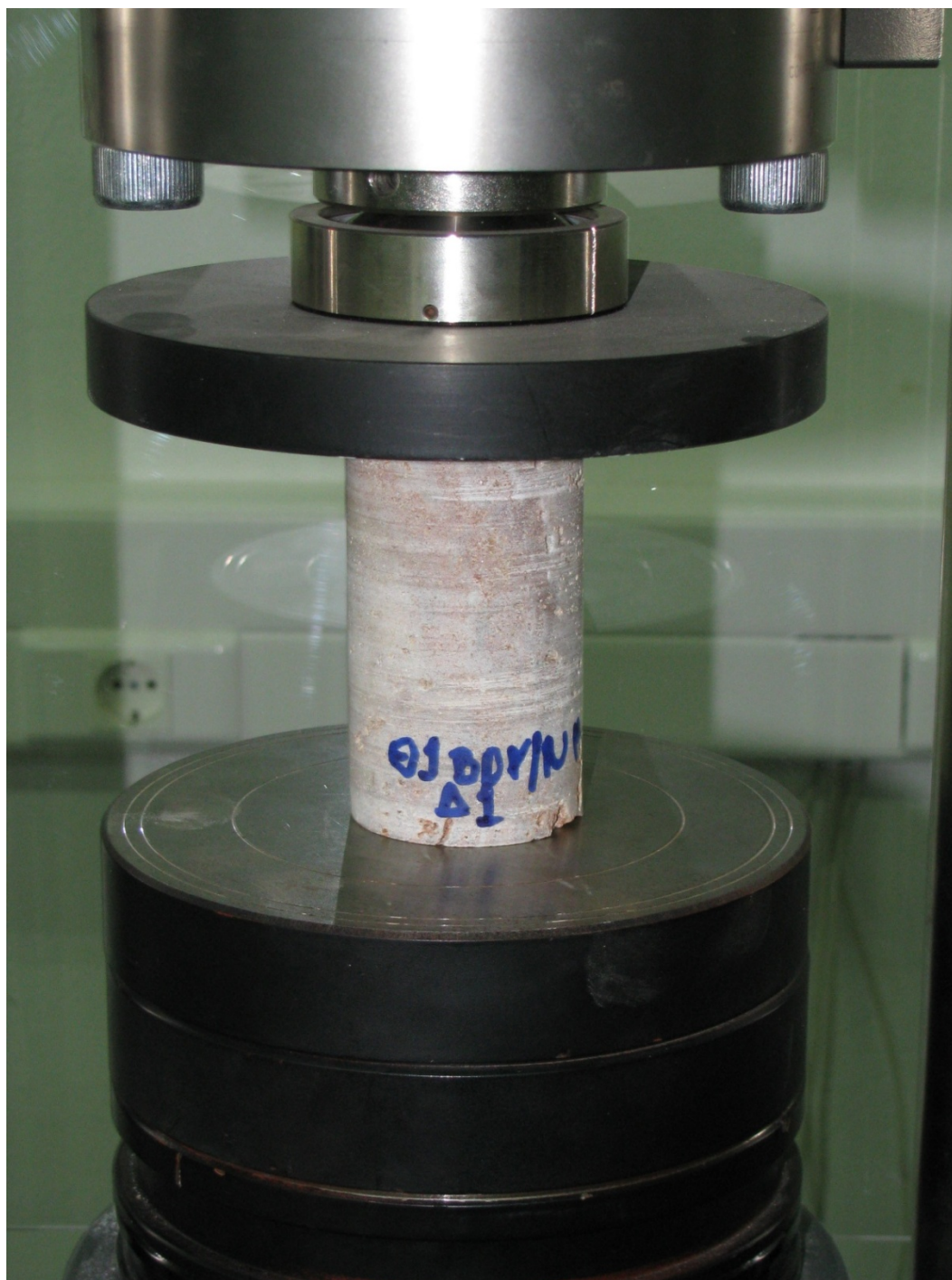
Εικόνα 5.30 Δοκίμιο τραβερτίνη τοποθετημένο στην θλιπτική μηχανή.
