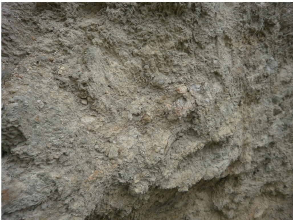
Εικόνα 5.48 Αποσαθρωμένη ζώνη σχιστολίθου.
