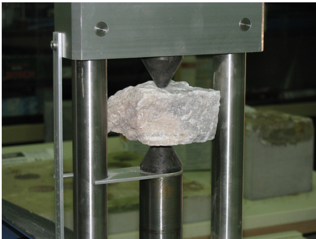
Εικόνα 3.12 Δοκιμή σημειακής φόρτισης ακανόνιστου δείγματος.
