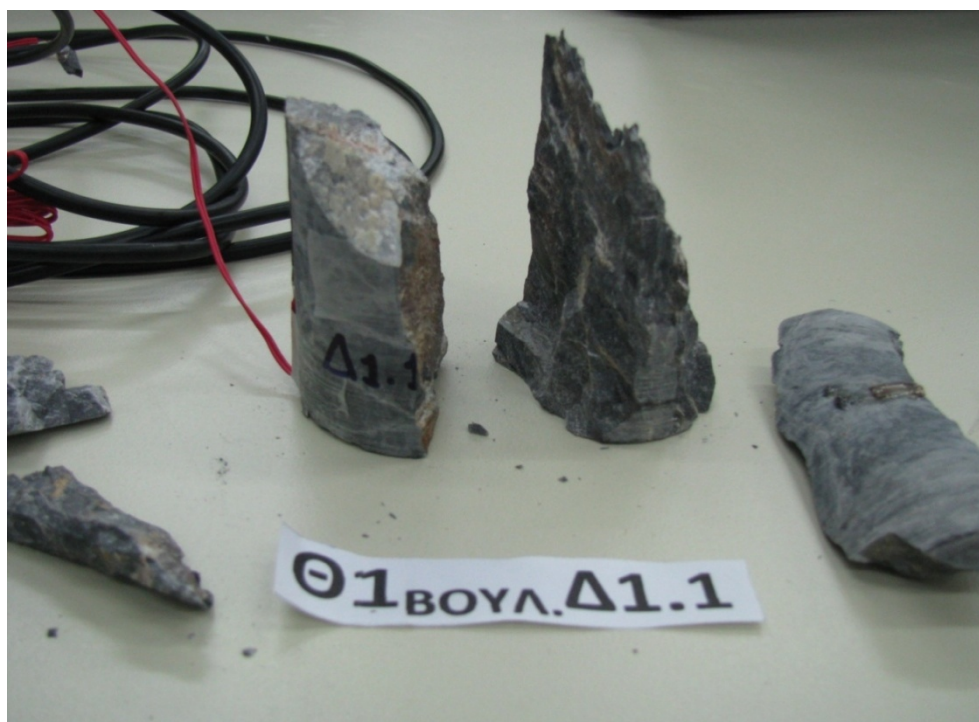
Εικόνα 5.65 Τα υπολείμματα δολομίτη μετά τη θλίψη.
