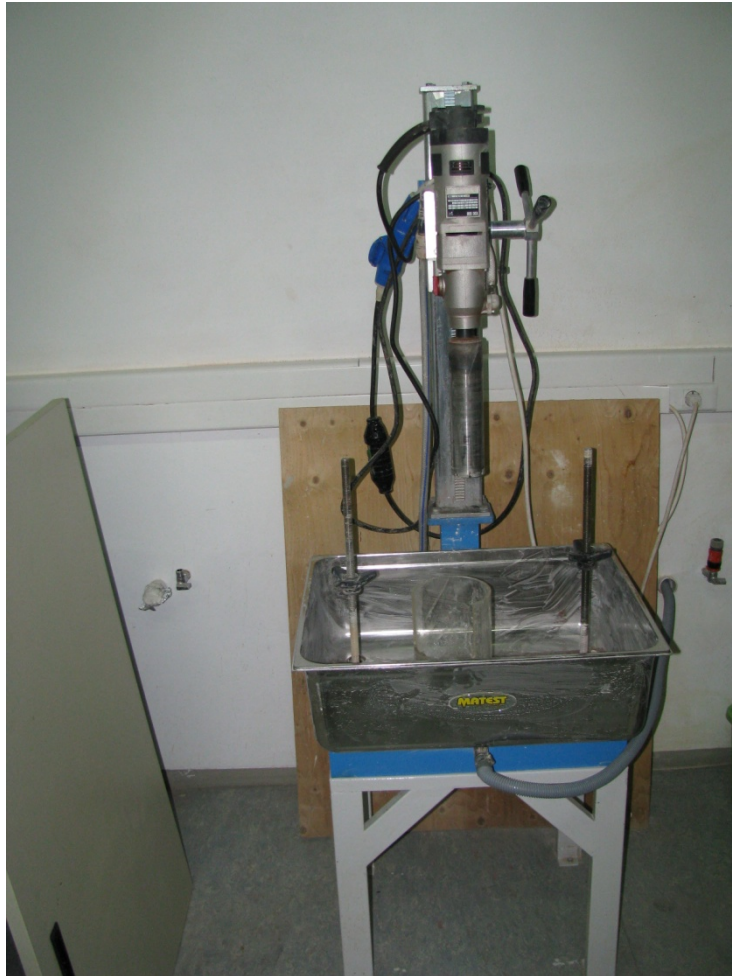
Εικόνα 3.1 Το τρυπάνι διαμόρφωσης των πυρήνων (καρότα) πετρώματος του εργαστηρίου Τεχνικής Γεωλογίας της σχολής Μηχανικών Μεταλλείων - Μεταλλουργών.
