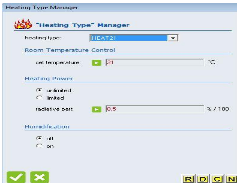
Εικόνα 7.24 : Παράθυρο επεξεργασίας του συστήματος θέρμανσης.
