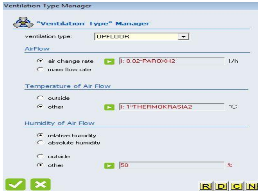
Εικόνα 8.9 : Ρύθμιση του αερισμού της θερμικής ζώνης του πρώτου ορόφου.
