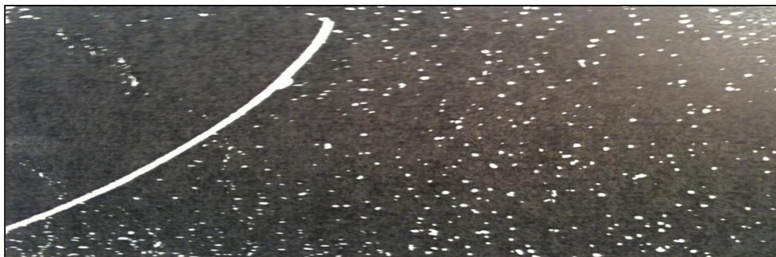
Σχήμα 1.5: Τυπική εικόνα των στιγμάτων-ειδώλων στο καταγραφικό φιλμ από τις σκεδάσεις του προσπίπτοντος φωτός των σωματιδίων. Η συγκέντρωση δεν είναι μεγάλη και συνεπώς οι τροχιές τους δεν διασταυρώνονται.
