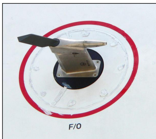
Σχήμα 1.1: Σωλήνας Pitot προσκολλημένος σε φτερό αεροσκάφους για τη μέτρηση της ταχύτητας του αέρα.
