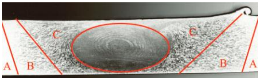
Εικόνα 7 Ανάλυση ζωνών μικροδομής σε συγκόλληση FSW του κράματος αλουμινίου 2024. Α) Βασικό μέταλλο ανεπηρεαστο από την διεργασία.
