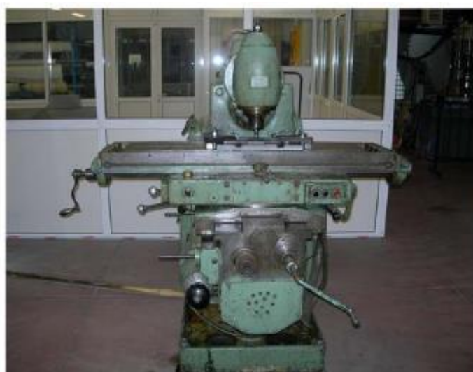
Εικόνα 22 Η μεταποιημένη φρέζα - μηχανή συγκόλλησης δια τριβής με ανάδευση του Εργαστηρίου Ναυπηγικής Τεχνολογίας
