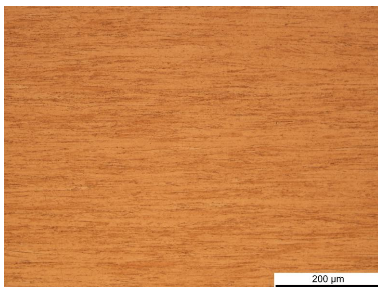
Σχήμα 19: Οπτικές μικρογραφίες που έχουν υποστεί χημική προσβολή με FeCl_3 για δείγμα που δεν έχει υποστεί θερμικές κατεργασίες. Μεγέθυνση \times 5 , \times 20 . Και στις δύο εικόνες φαίνονται σε όλη την επιφάνεια οι γραμμές έλασης.
