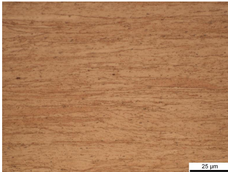
Σχήμα 20: Οπτική μικρογραφία που έχουν υποστεί χημική προσβολή με FeCl_3 για δείγμα που δεν έχει υποστεί θερμικές κατεργασίες. Μεγέθυνση \times 100 . Στη συγκεκριμένη φωτογραφία φαίνονται πάλι οι γραμμές έλασης καθώς επίσης και ένα σωματίδιο που προϋπήρχε από τη διαδικασία παραγωγής.
