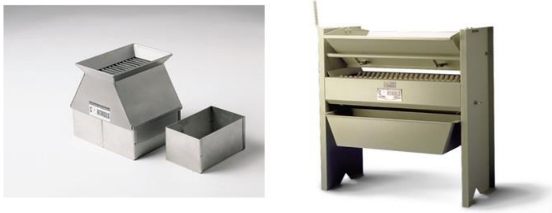
ΕΙΚΟΝΑ 8. ΤΕΤΡΑΜΕΡΙΣΤΗΡΕΣ ΜΕ ΣΤΑΘΕΡΑ ΚΑΙ ΜΕΤΑΒΛΗΤΑ ΑΝΟΙΓΜΑΤΑ
