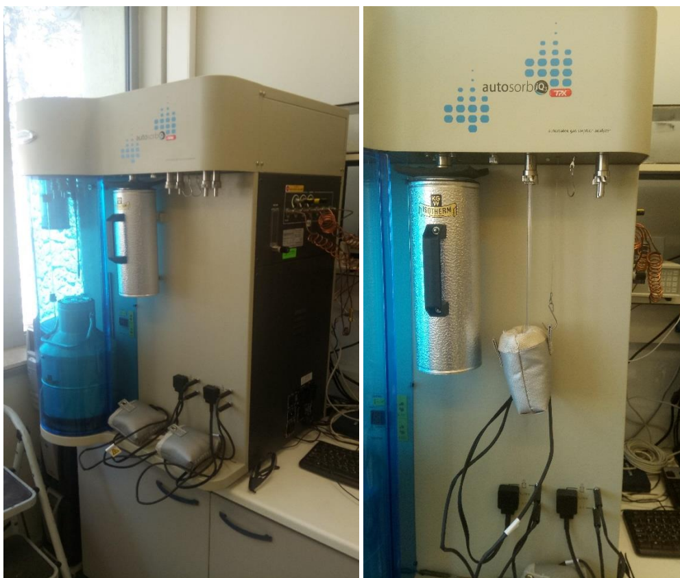
Εικόνα 7.5.1. Η συσκευή ποροσιμετρίας N 2 (Quantachrome autosorb iq3) που χρησιμοποιήθηκε (HYSORBLab, Ε.Κ.Ε.Φ.Ε «Δημόκριτος»).
