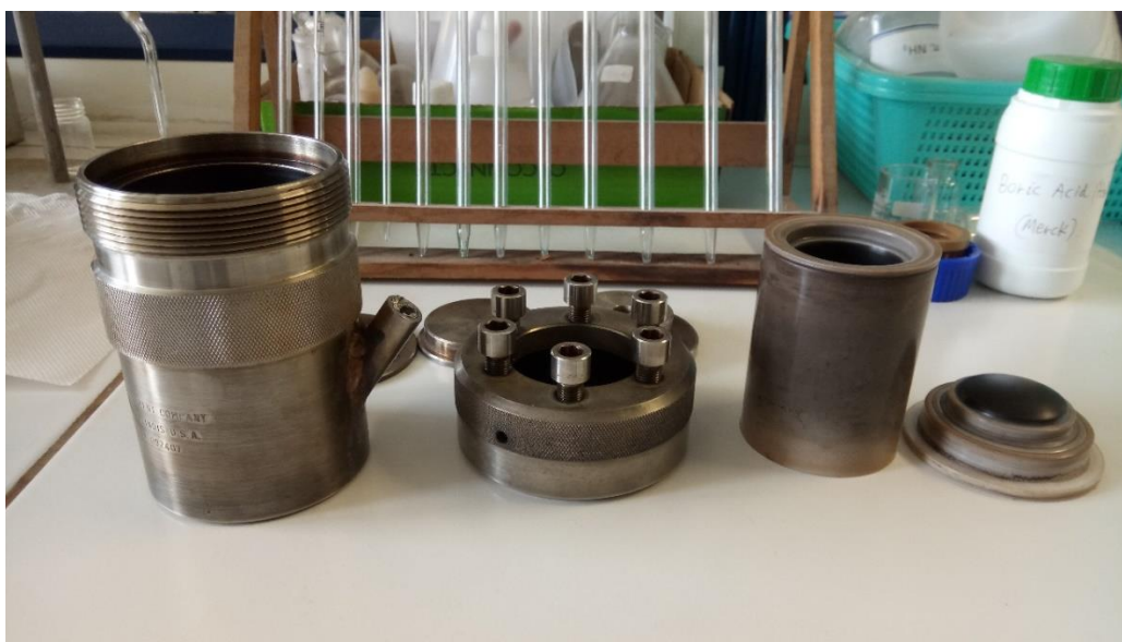
Εικόνα 6.1. Το αυτόκλειστο δοχείο ανοξείδωτου χάλυβα μαζί με την κάψουλα Teflon που χρησιμοποιήθηκε στην παρούσα σύνθεση του νανοϋβριδικού υλικού.
