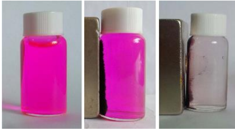
Εικόνα 4.2.2. Απορρόφηση μπλε του μεθυλενίου (πάνω εικόνα) και ροδαμίνης Β (κάτω εικόνα) συγκέντρωσης 20mg/L μετά από προσθήκη νανοσωματιδίων Fe_3O_4(II) και νανοϋβριδικού υλικού GO/Fe_3O_4 μετά από 12 ώρες επαφή υπό συνεχή ανάδευση. Τα υλικά παρατηρούνται στα τοιχώματα αριστερά λόγω μαγνητικής έλξης από εξωτερικό μαγνήτη. {51}
