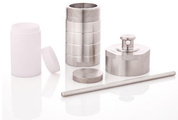
Εικόνα 5.2. Αυτόκλειστο δοχείο του εμπορίου από ανοξείδωτο χάλυβα και κάψουλα Teflon. {58}
