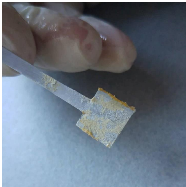
Εικόνα 44. Απόθεση πειράματος ηλεκτρόλυσης TEGDME/BMPTFSI(1:2)/ScCl 3
