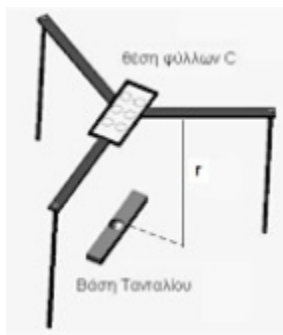
Εικόνα 3.6: Σχηματική αναπαράσταση της διάταξης της εξάχνωσης.
