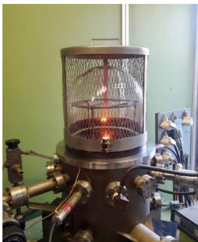
Εικόνα 3.5: Ο εξαχνωτήρας του Ε.Κ.Ε.Φ.Ε. «Δημόκριτος» κατά τη διάρκεια πραγματοποίησης εξαχνωσης.
