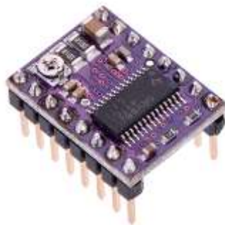
Εικόνα 5.11: Μορφή Driver DRV8825
