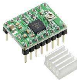
Εικόνα 5.15: Μορφή Driver A4988
