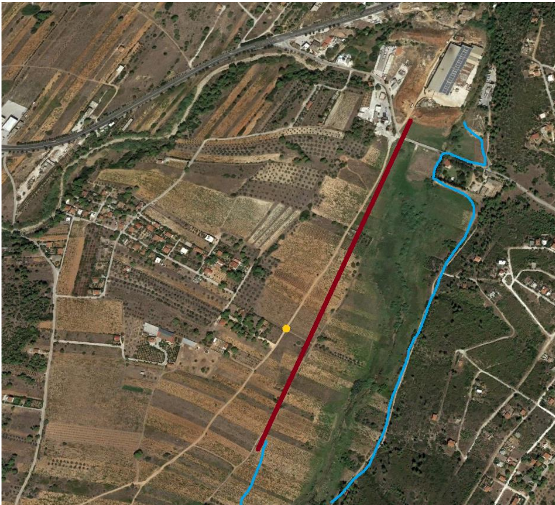
Εικόνα 3-68: Εικόνα από Google Earth με την προτεινόμενη οριοθέτηση με αναχώματα στη Θ11 (κόκκινο). Με μπλε φαίνονται τα εκτιμώμενα όρια στάθμης και με κίτρινο η θέση από την οποία λήφθηκε η Εικόνα 3-69 από Google Maps.
