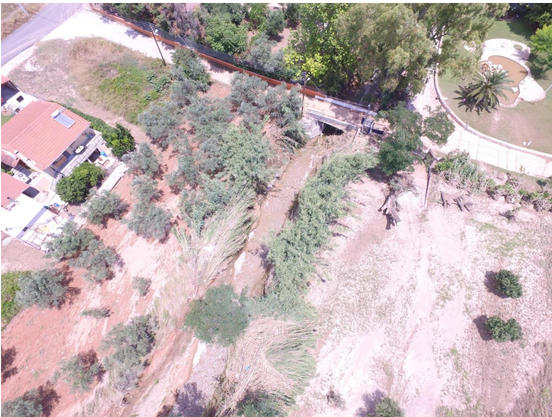
Εικόνα 3-46: Αεροφωτογραφία της Θ7. Φαίνεται η στένωση της κοίτης λόγω του τεχνικού έργου.
