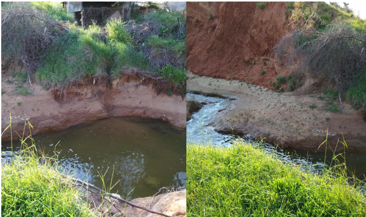
Εικόνα 3-72: (Αριστερά) Ανθρωπογενείς αποθέσεις της Θ12. (Δεξιά) Δυσδιάβρωτη άργιλος στη βάση του πρηνούς της Θ12.
