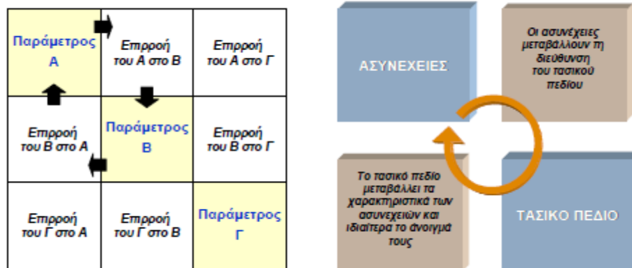
Εικόνα 5.5 - (α). Αρχή λειτουργίας του πίνακα αλληλεπίδρασης, και (β). εξέταση της αλληλεπίδρασης (Hudson, 1991; 1992).
