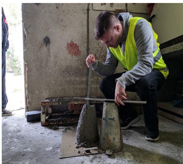
Εικόνα 4.9: Διαδικασία και μέτρηση κάθισης
