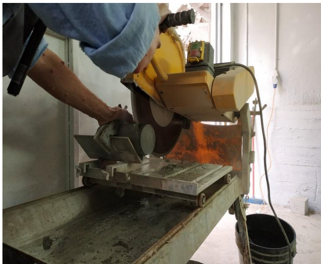
Εικόνα 4.25: Κοπή κυλινδρικών δοκιμίων
