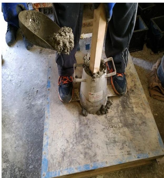
Εικόνα 4.10: Πλήρωση κώλυρου εξάπλωσης
