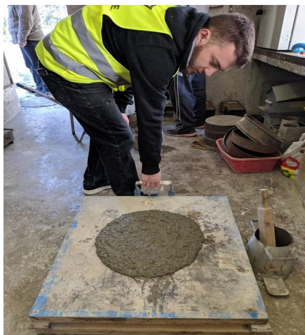
Εικόνα 4.11: Χειροκίνητη ανύψωση βάσης
