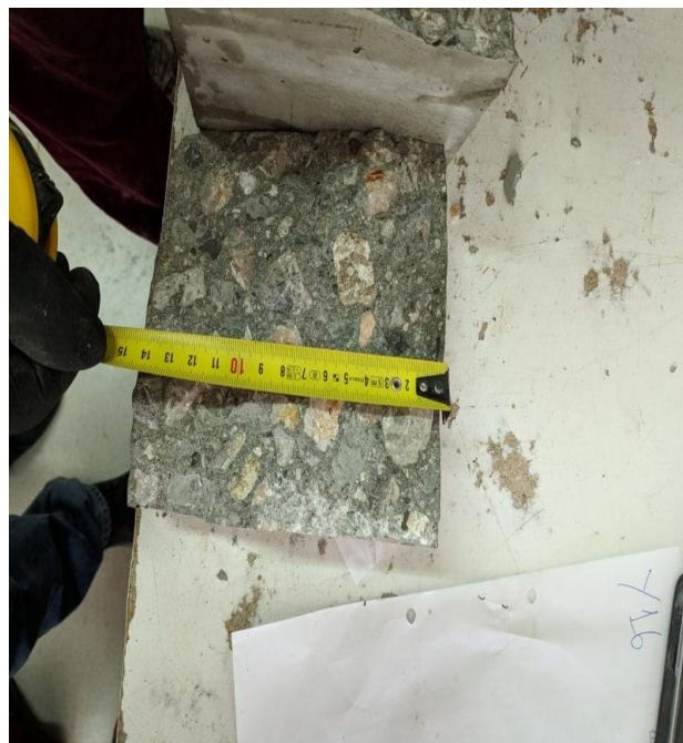
Εικόνα 4.19: Μέτρηση βάθους διείσδυσης
