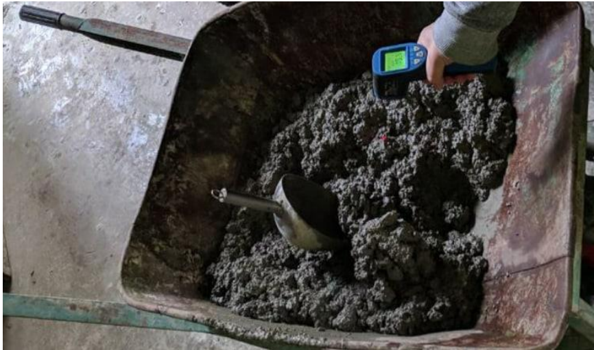
Εικόνα 4.7: Μέτρηση θερμοκρασίας σκυροδέματος
