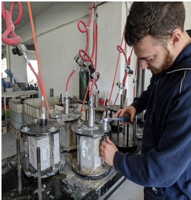
Εικόνα 4.18: Διάταξη δοκιμής υδατοπερατότητας (κατά EN 12390-8)
