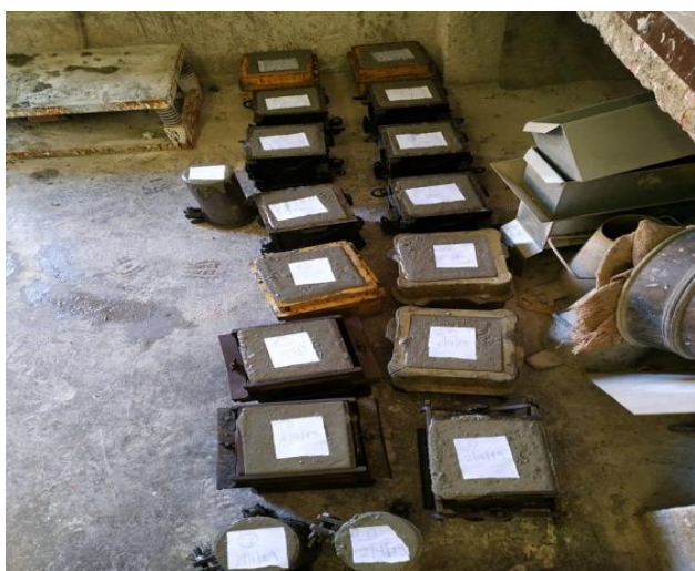
Εικόνα 4.1: Πληρωμένες μήτρες σκυροδέματος
