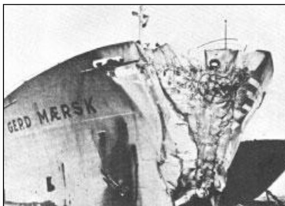
Εικ. 5.92 Τάνκερ μετά την πτώση στο βάθρο της γέφυρας Suspension [Svensson H. 2009].
