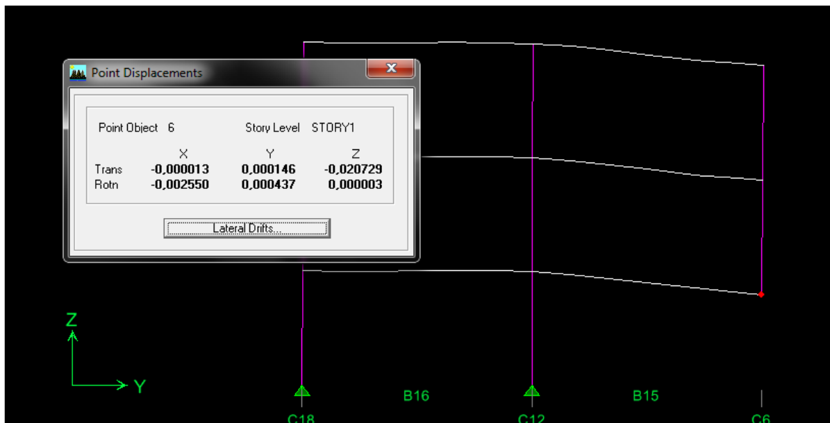
Εικ. 4.84 Βύθιση κόμβου λόγω απομάκρυνσης του C6.
