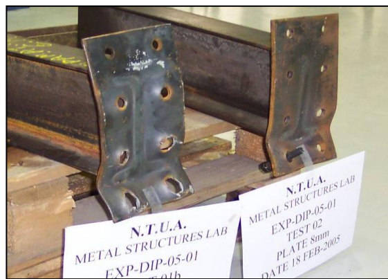
Εικ. 4.52 Αστοχία μετωπικής πλάκας σε σύνδεση ροπής [Bagias I et al. 2008].
