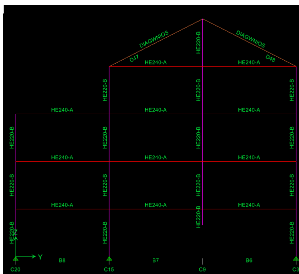
Εικ. 4.19 Πλάγια τομή όπου διακρίνονται οι διαγώνιοι για την ανάρτηση των υποστυλωμάτων C3 και C15.
