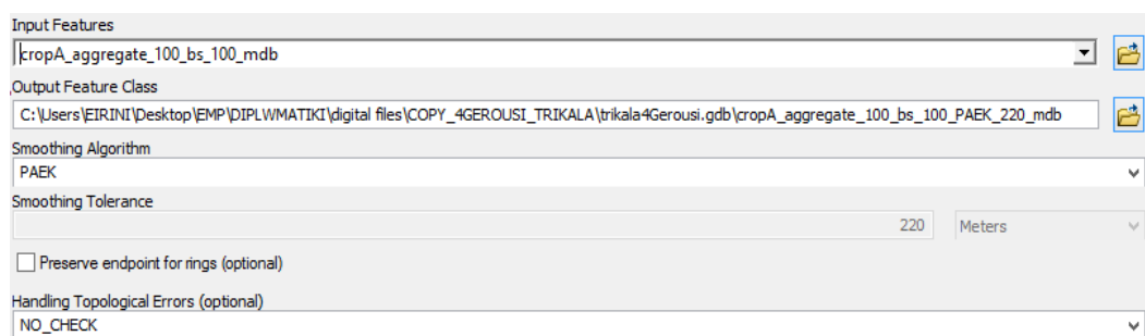
Εικόνα 55: Καθορισμός τιμών παραμέτρων στο εργαλείο Smooth Polygon
