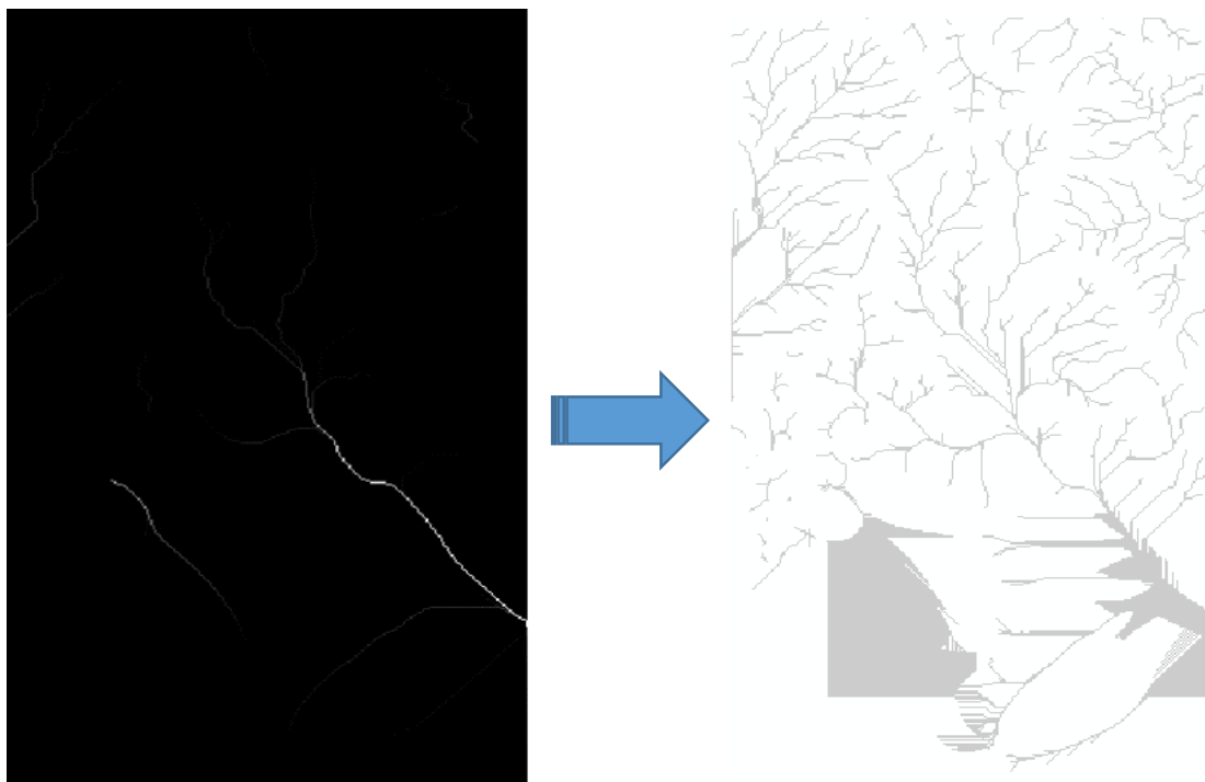
Εικόνα 16: Δημιουργία του υδρογραφικού δικτύου σε κανονικοποιημένη δομή, από τον κάναβο συγκεντρωτικής ροής
