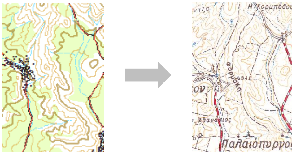
Εικόνα 63 : Οι παράγωγες ισοϋψείς (αριστερά) σε σύγκριση με τις ισοϋψείς του δοθέντος Φύλλον Χάρτη κλίμακας 1:100.000 (δεξιά)
