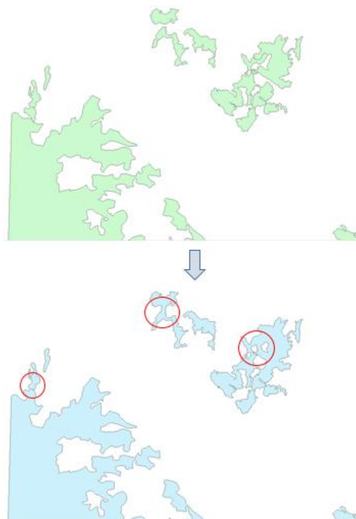
Εικόνα 52: Εφαρμογή του εργαλείου Aggregate Polygons σε τμήμα της περιοχής μελέτης
