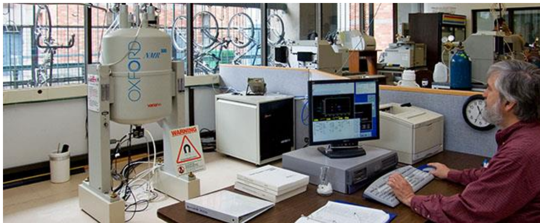
Σχήμα 3.12: Εικόνα ενός εργαστηρίου NMR όπου φαίνεται ο μαγνήτης και η κονσόλα του υπολογιστή από όπου ο χειριστής διεξάγει τα πειράματα. Πηγή: [38]
