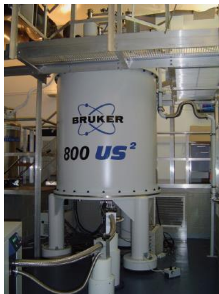
Σχήμα 3.3: Υπεραγωγίμος μαγνήτης NMR 18.8 T για διεξαγωγή πειραμάτων ^1\text{H} σε συχνότητα 800 MHz ο οποίος βρίσκεται στο πανεπιστήμιο Imperial στο Λονδίνο. Πηγή: [26]
