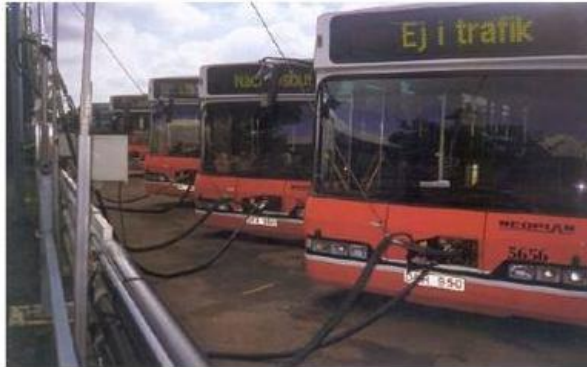
Σχήμα 8. Σταθμός διανομής και οχήματα που κινούνται με βιοαέριο στη Σουηδία.
