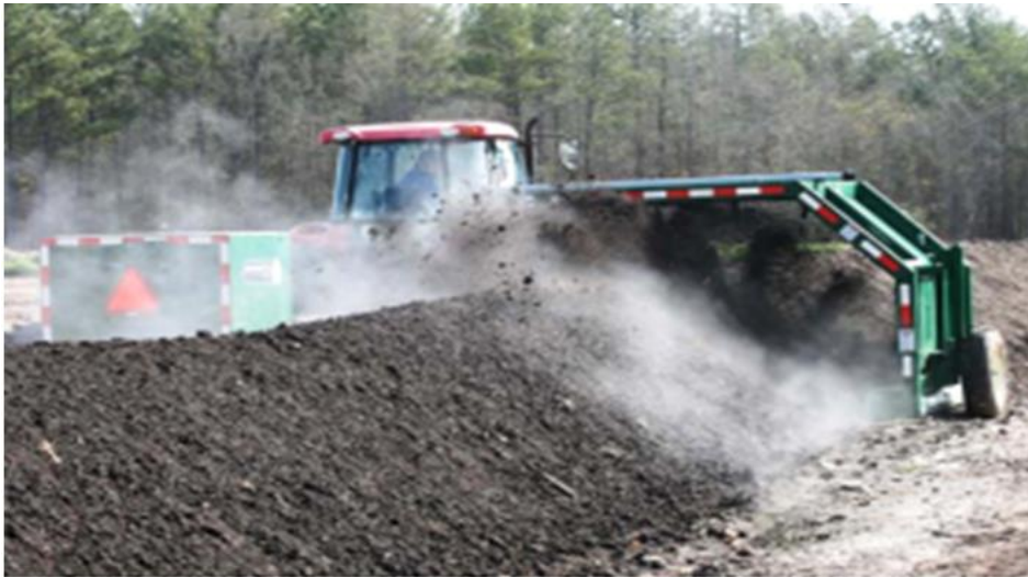
Σχήμα 3. Ανάδευση και αερισμός του υλικού
