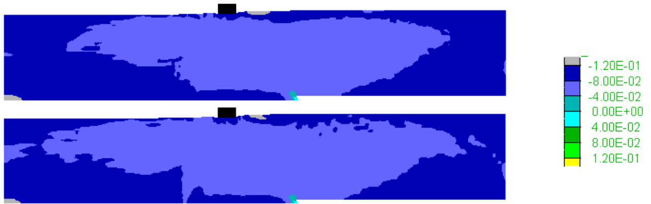
Σχήμα 5.63 Ανισοτροπική παράμετρος κατάστασης ζ σε αμμώδη στρώση σχετικής πυκνότητας D_r=65\% με οριζόντια δομή , με κατασκευή ( B=4m ) στη θέση C=16m φορτίου q=90kPa (πάνω) και q=180kPa (κάτω), για διάρρηξη ανάστροφου ρήγματος γωνίας \beta=135^\circ με μετατόπιση d = 1.0m .
