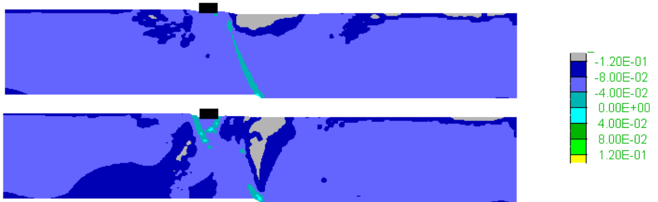
Σχήμα 6.37 Ανισοτροπική παράμετρος κατάστασης \zeta σε αμμώδη στρώση σχετικής πυκνότητας D_r=65\% με κατακόρυφη δομή για διάρρηξη κανονικού ρήγματος ( \beta=45^\circ ) με κατακόρυφη μετατόπιση d=1.0\text{m} , όταν υπάρχει κατασκευή ( B=4\text{m} ) στη θέση C=12m με φορτίο q=90\text{kPa} (πάνω) και q=180\text{kPa} (κάτω)
