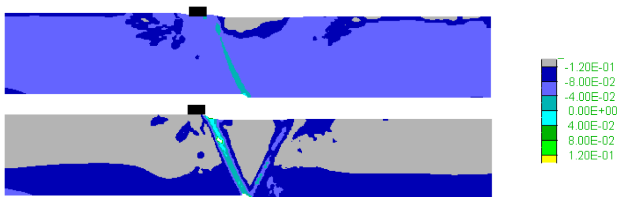
Σχήμα 6.7 Ανισοτροπική παράμετρος κατάστασης \zeta σε αμμώδη στρώση σχετικής πυκνότητας D_r=65\% με κατακόρυφη δομή (άνω) και οριζόντια δομή (κάτω) κόκκων, με κατασκευή (πλάτους B=4\text{m} ) στη θέση C=12\text{m} , για διάρρηξη κανονικού ρήγματος ( \beta=45^\circ ) με κατακόρυφη μετατόπιση d = 1.0\text{m} .
